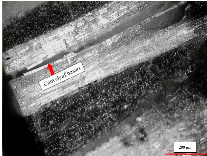
Şekil 7.51. %1 oranda ÇCKNT takviyeli Nano-elyaf keçe içeren bir numunenin darbe merkezinden geçen kırılmaya ait kısmın optik mikroskop görüntüsü ve Cam elyafın hasar gelişimi (100X)
