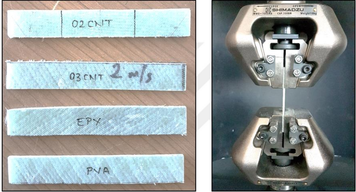
Şekil 6.5. Çekme numuneleri ve çekme cihazı aparatına bağlanması
