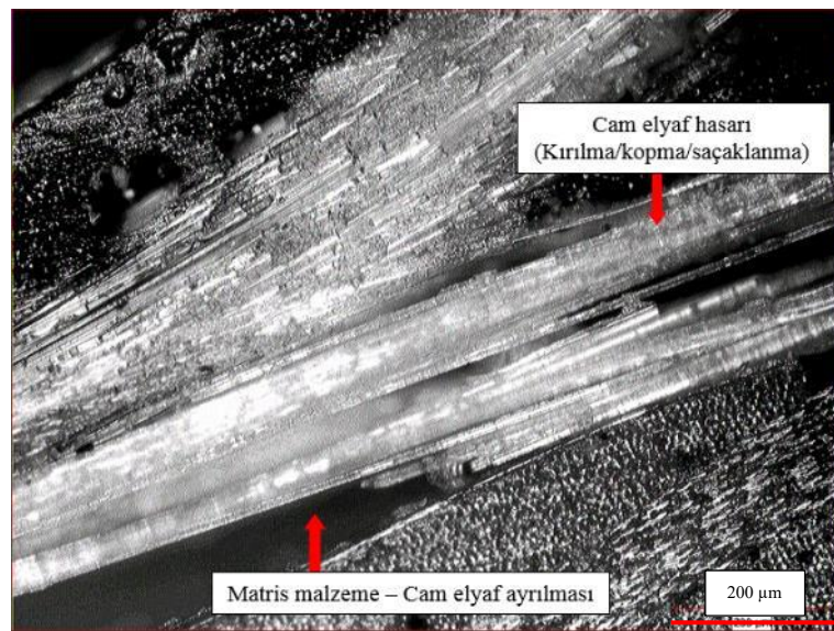
Şekil 7.53. PVA Nano-elyaf keçe içeren bir numunede Cam Elyaf Hasarı (kırılma/ kopma/ saçaklanma) ve Delaminasyon hasar gelişimine ait optik mikroskop görüntüsü (100X)
