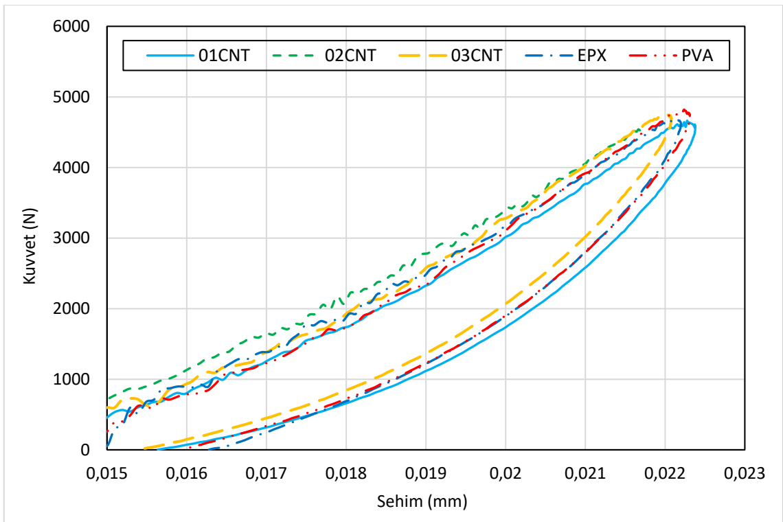
Şekil 7.20. 2.5 m/s hızdaki Darbe Testi sonuç grafikleri (Kuvvet-Sehim Grafikleri)
