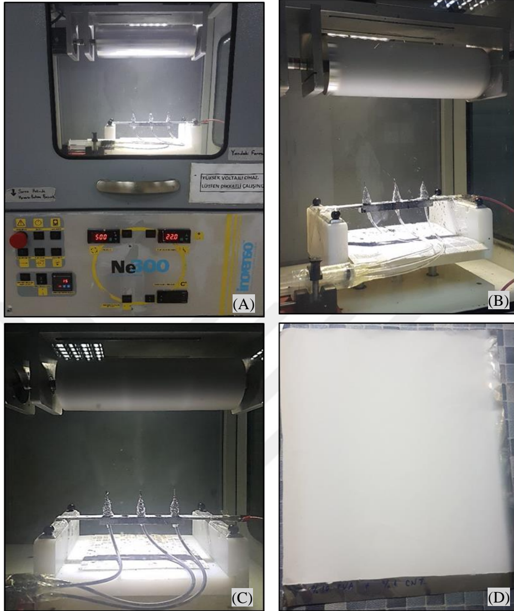
Şekil 5.4. PVA/ÇCKNT çözeltilisinden Elektro-Eğirme yöntemiyle nano elyaf keçe üretimi işlemlerinin aşamaları (A: Cihazın üretim esnasında görünümü, B: Sistemin detaylı görünümü, C: Üretim esnasında nanoelyafların oluşumu, D: Üretimi gerçekleştirilmiş nanoelyaf keçe)
