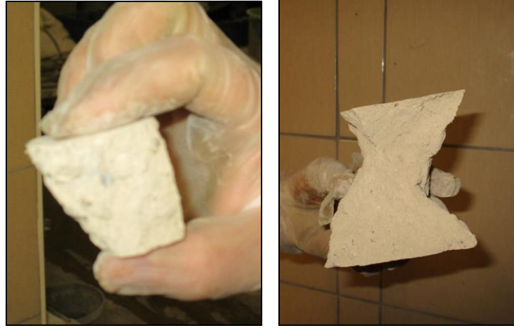
Şekil 3.58. a) Alçı katkılı ve b) Çimento katkılı numunelerde gözlenen kum saati şeklinde iflas modu
