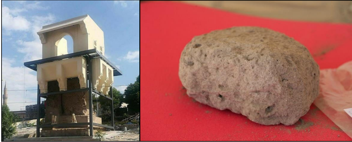
Şekil 3.20. a) Kılıçarslan Köşkü Saray kalıntısı b) Kılıçarslan Köşkü Saray kalıntısı kerpiç numunesi (Örnek 1)
