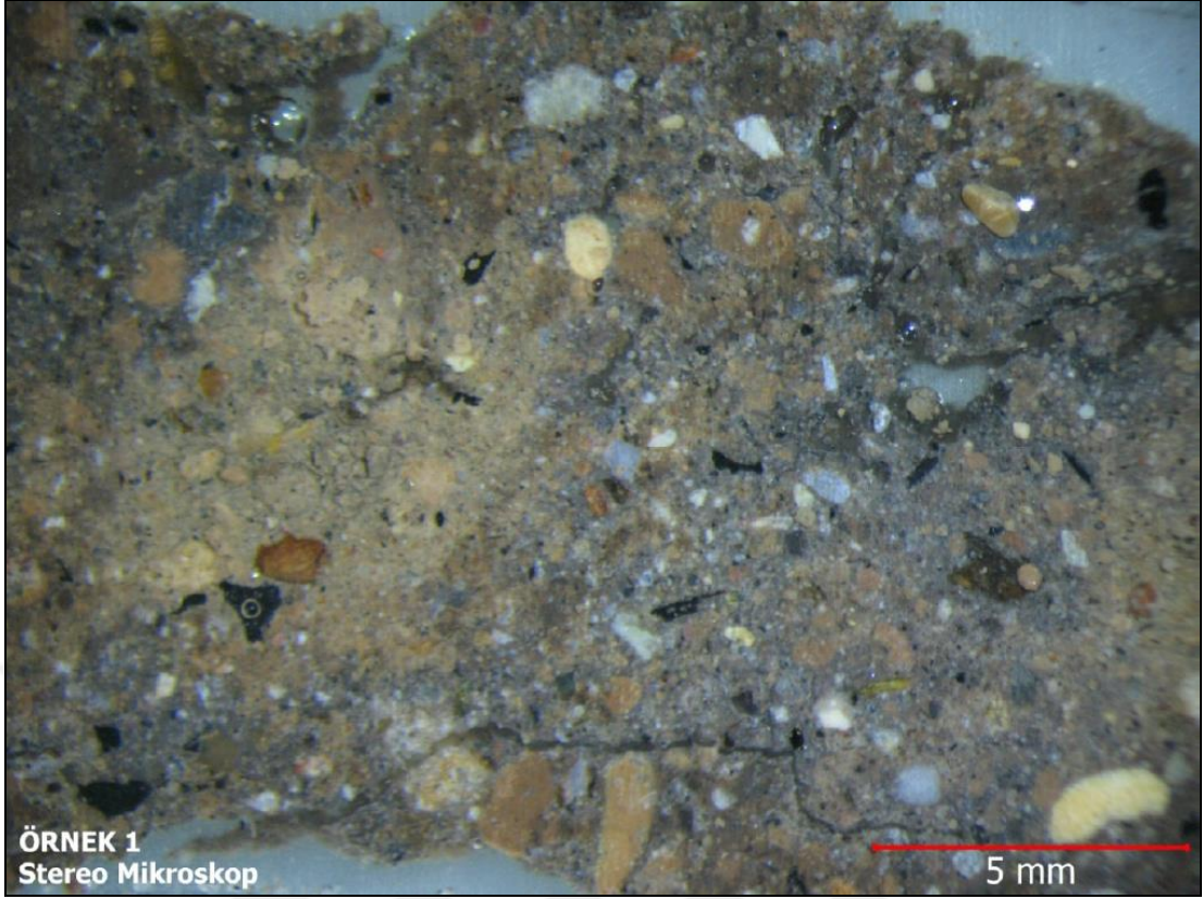
Şekil 3.31. Tescilsiz yığma kerpiç yapı kerpiç numunesi (Örnek 1)–Stereo mikroskop görüntüsü
