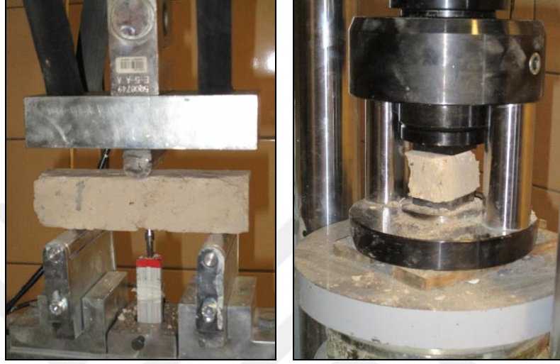
Şekil 3.57. a) Eğilme dayanımı testi b) Basınç dayanımı testi
