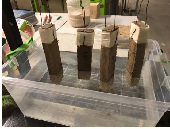
Şekil 3.53. 20x5x2cm'lik saman-kireç katkılı numunelerin çamurlaşma deneyi.
