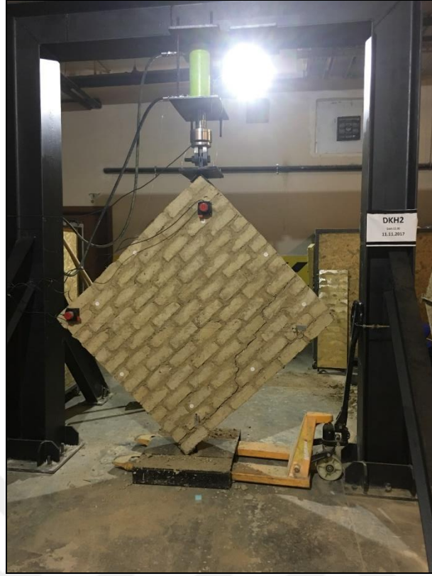
Şekil 3.67. Duvar numunesi ASTM E519/E519M-15 deney standardı deney düzeneğine yerleştirilerek diyagonal kayma deneyleri gerçekleştirilmiştir.
