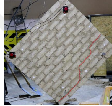
Şekil a) Çatlama deformasyonu
