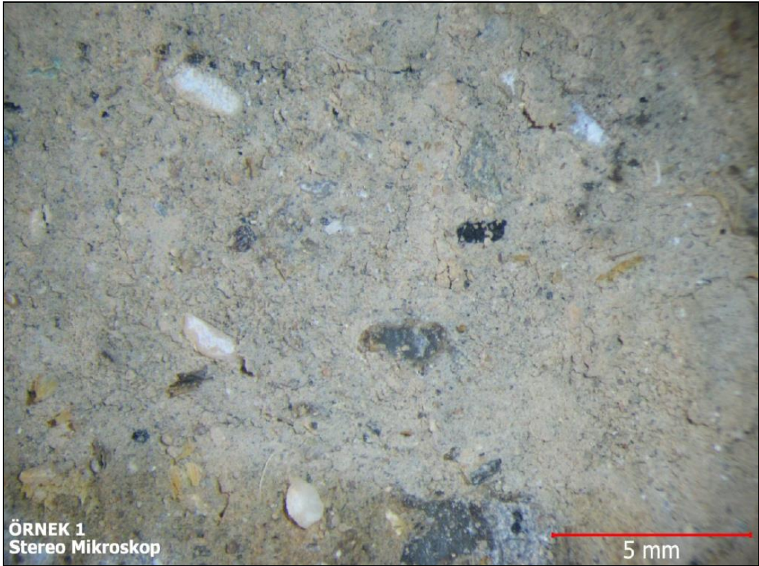
Şekil 3.42. Tescilli yığma kerpiç yapı harç numunesi (Örnek 1)–Stereo mikroskop görüntüsü
