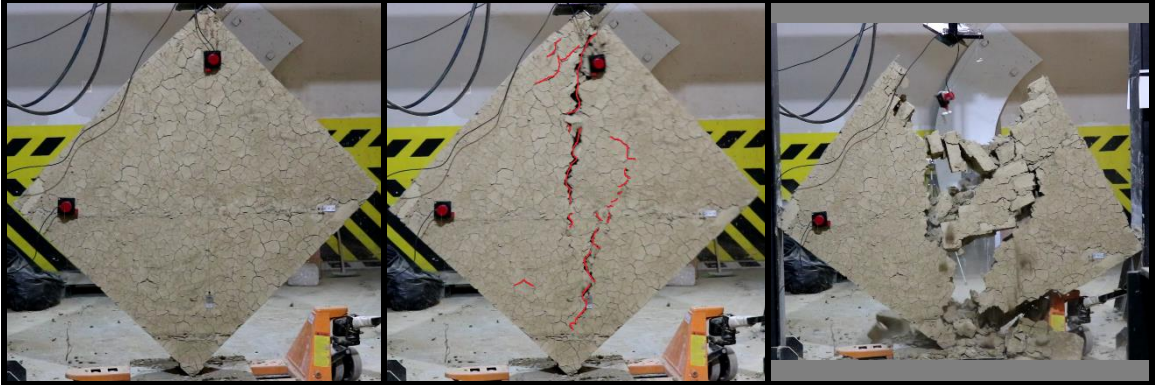
DÇHS2 ÇATLAMA İLERLEYİŞİ
