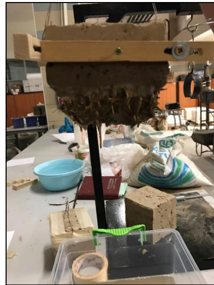
Şekil 3.52. a), b) 12x12x12cm’lik numunenin yarısı suya daldırılmış ve 45 dakika bekletilmiş hali.
