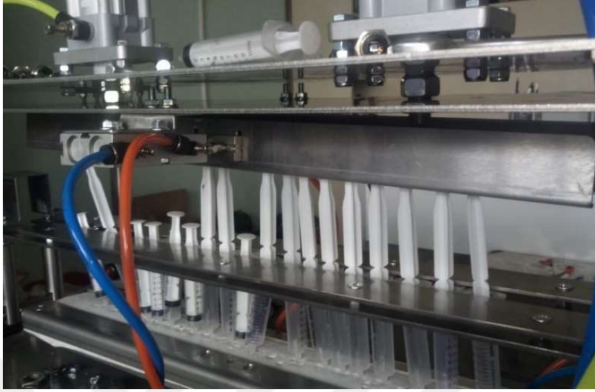
Şekil 1.3. Firmanın geliştirmiş olduğu enjektör sızdırmazlık test sistemi
