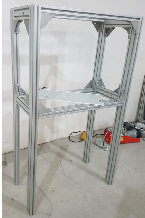
Şekil 3.6. Kamera ve aydınlatmanın sabitlendiği platform
