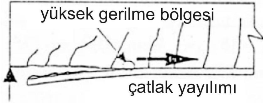
Şekil 2.23. CFRP sargısının uç kısımlarının ayrışması sonucu gerçekleşen göçme (Gürol, 2007)
