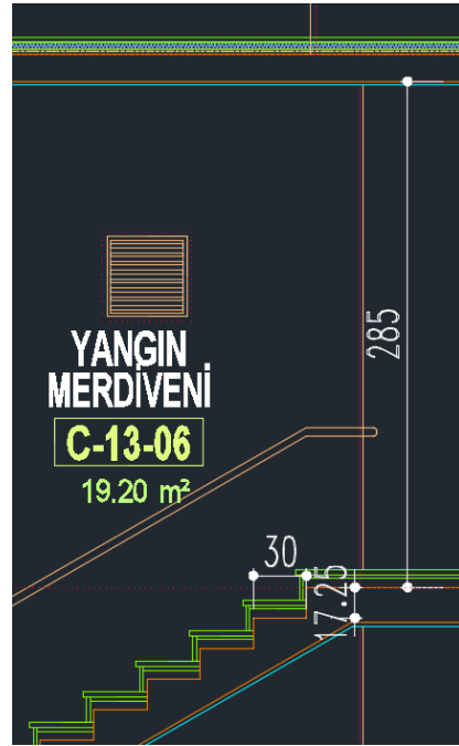
b) Merdiven kesitinde basamak yüksekliği, genişliği ve en düşük baş kurtarma mesafesi (cm)
