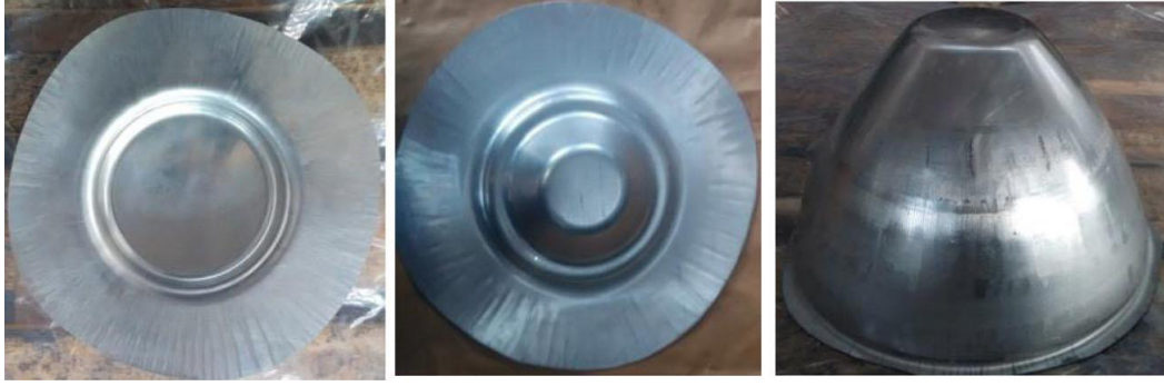
Şekil 2.16. 3 adım için ayrı ayrı şekillendirilmiş parçalar (Sun ve ark. 2017)
