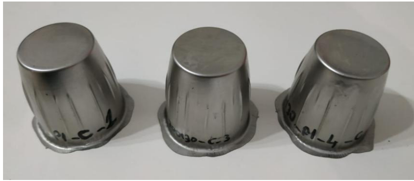
Şekil 4.20.2. Deney sonunda oluşan buruşma hasarı
