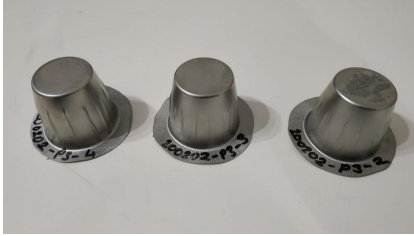
Şekil 4.17. 1.Deney sonunda oluşan buruşma hasarı
