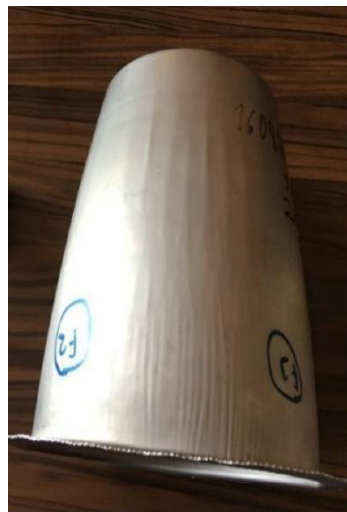
Şekil 3.2. Üzerinde buruşmalar olan başarıyla şekillendirilmiş endüstriyel çaydanlık
