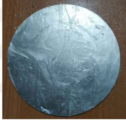
Őekil 3.18. Parafinle yađlanmış zerine PE film kaplanmış sac numune
