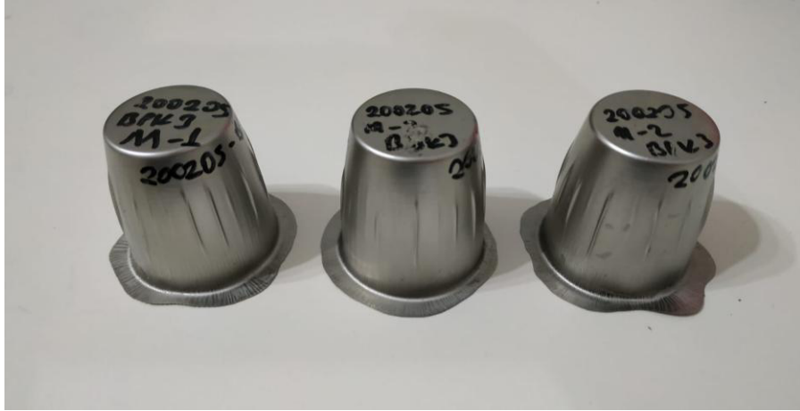
Şekil 4.29. 5. Deneyde oluşan BPK buruşmalı şekillendirme
