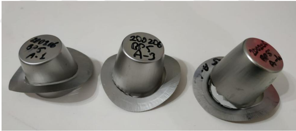
Şekil 4.32. 6. Deneyde oluşan yırtılmalı şekillendirme
