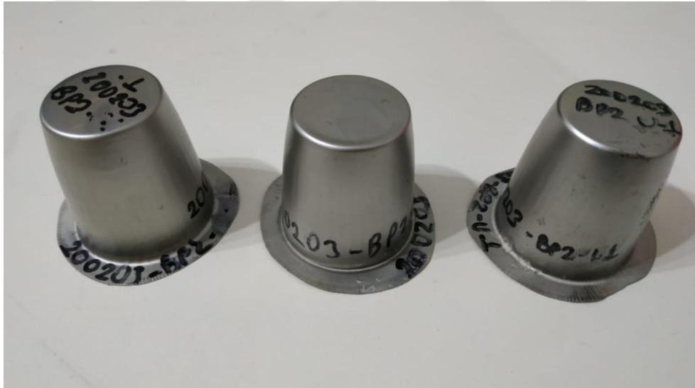
Şekil 4.26.4. Deneyde yırtılmasız ve buruşmasız şekillendirme
