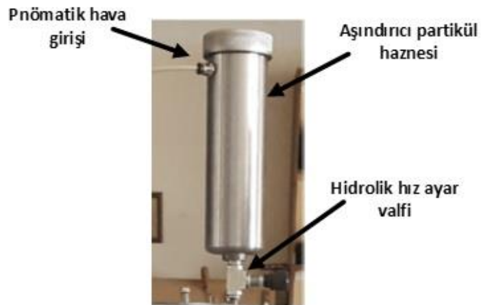
Şekil 3.25. Partikül besleme ünitesinin 3 nolu tasarımı.
