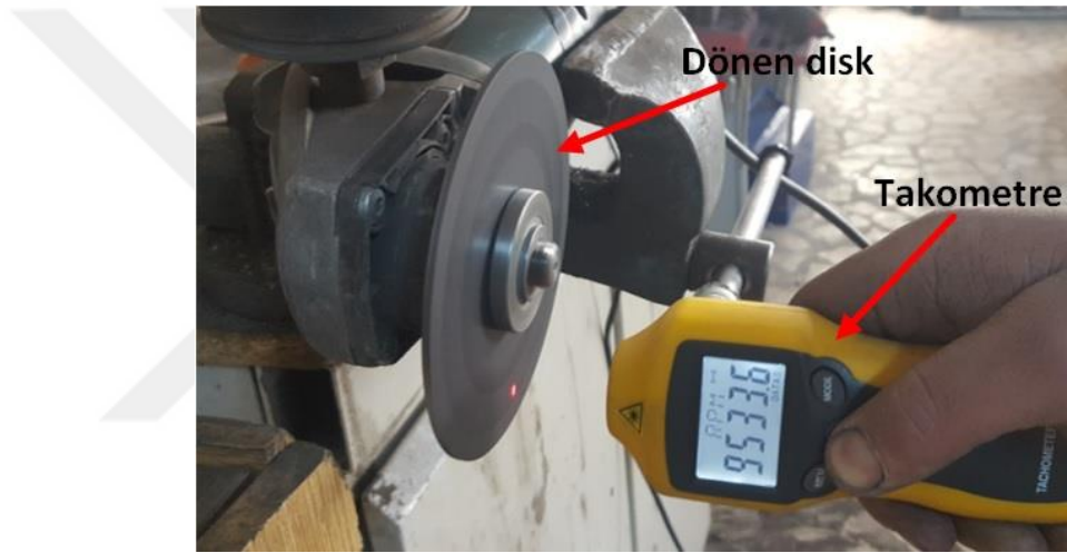
Şekil 3.32. Motor miline bağlı diskin dönme hızının takometre ile ölçülmesi.
