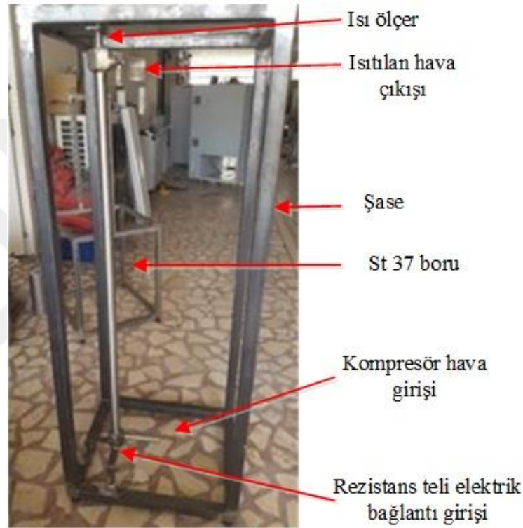
Şekil 3.5. Isıtma sisteminin 2 nolu tasarımına ait şase bağlantısı.
