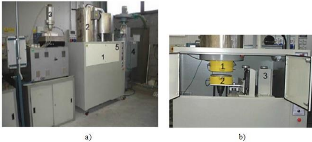
Şekil 2.7. Yüksek sıcaklıklarda testlerin yapılabildiği KPE test düzeneği fotoğraf görüntüleri; a) Tüm sistem, b) Nozul ve numune fikstürünün bulunduğu bir numaralı kısmın ayrıntılı görünüşü.
