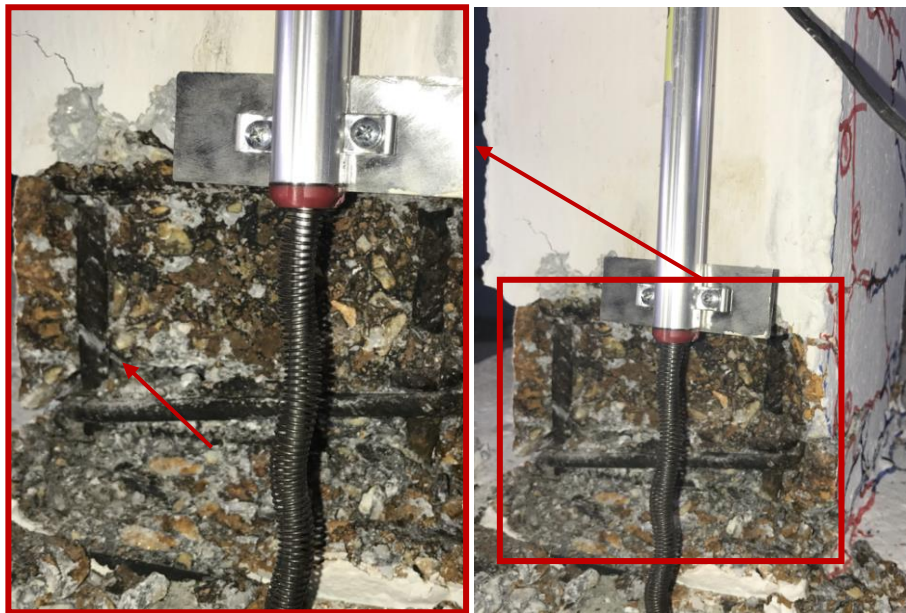
Şekil 4.90. UK20-%10 numunesinin deney sonu görünümü (devamı)(plastik mafsalsal bölgesi)
