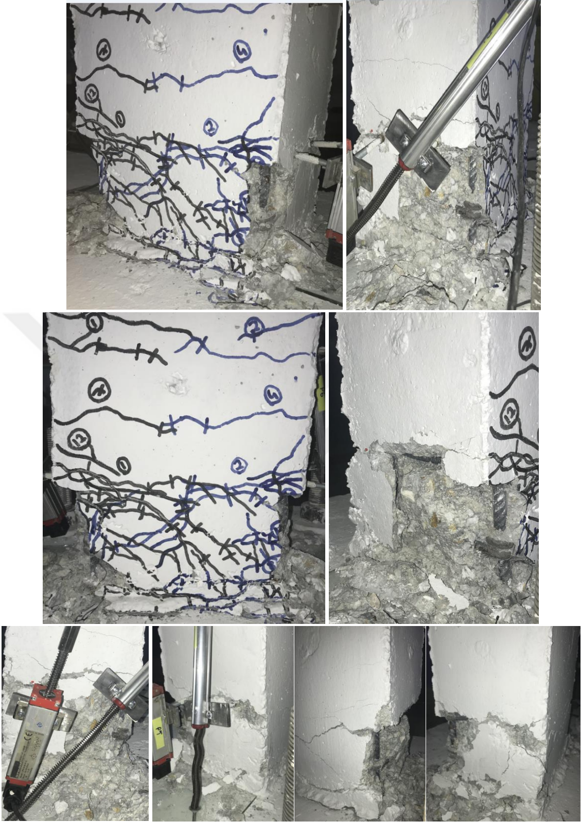
Şekil 4.54. YFC40-%0 numunesinin deney sonu görünümü (devamı) (plastik mafsal bölgesi)
