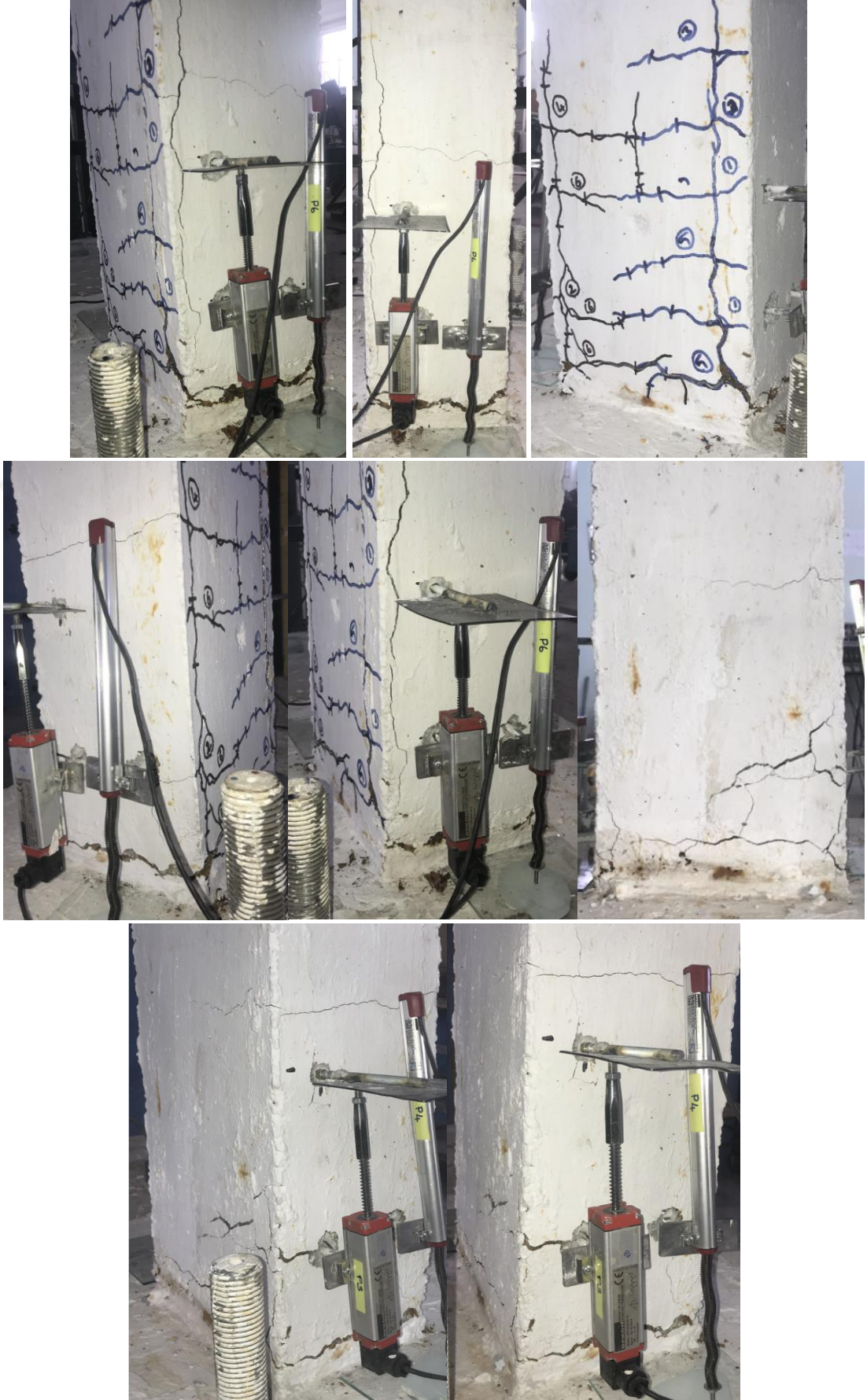
Şekil 4.116. Kontrol-%30 numunesinin deney sonu görünümü (devamı)(plastik mafsalsal bölgesi)
