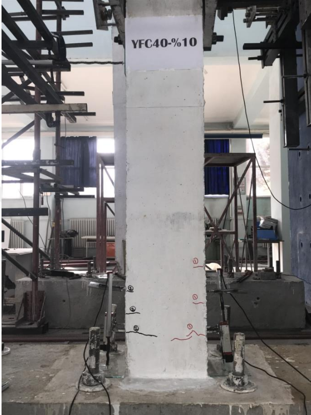
Şekil 4.102. YFC40-%10 deney numunesinde oluşan ilk çatlaklar
