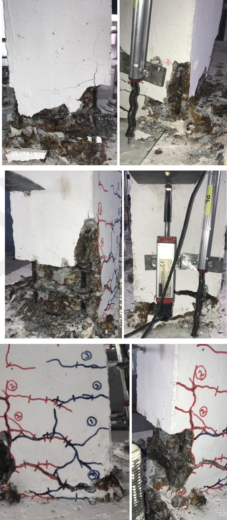
Şekil 4.78. UK10-%10 numunesinin deney sonu görünümü (devamı) (plastik mafsalsal bölgesi)
