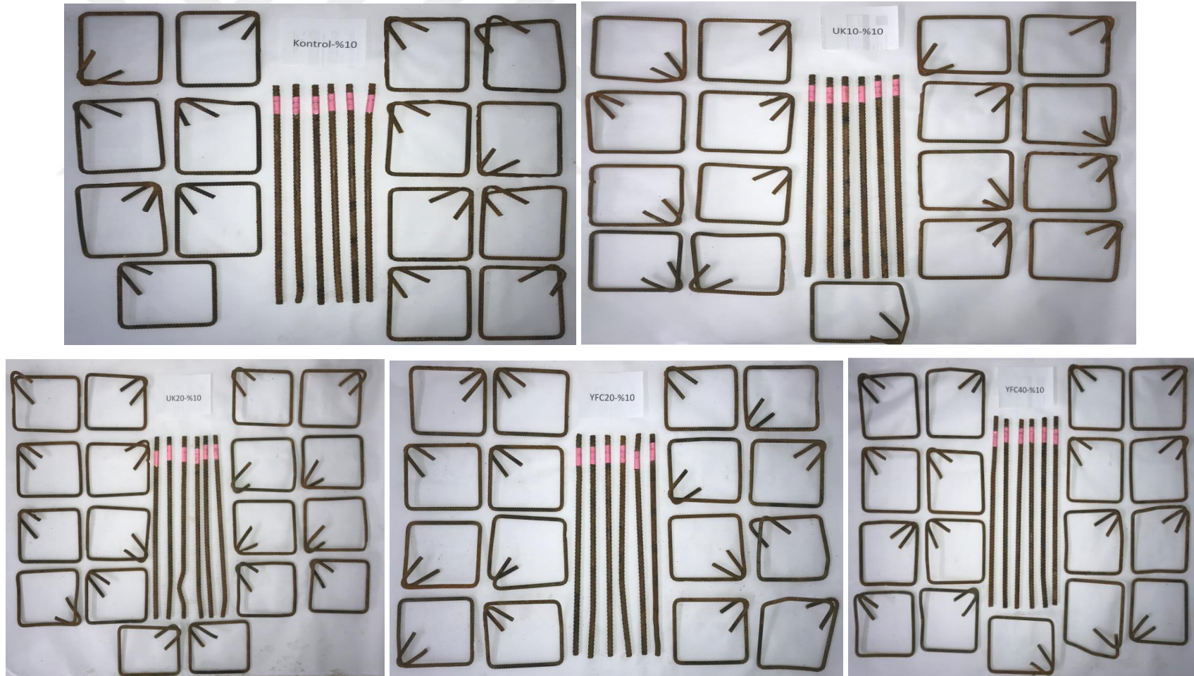
Şekil 4.199. Korozyon hasarı %10 olan numunelerin donatıları
