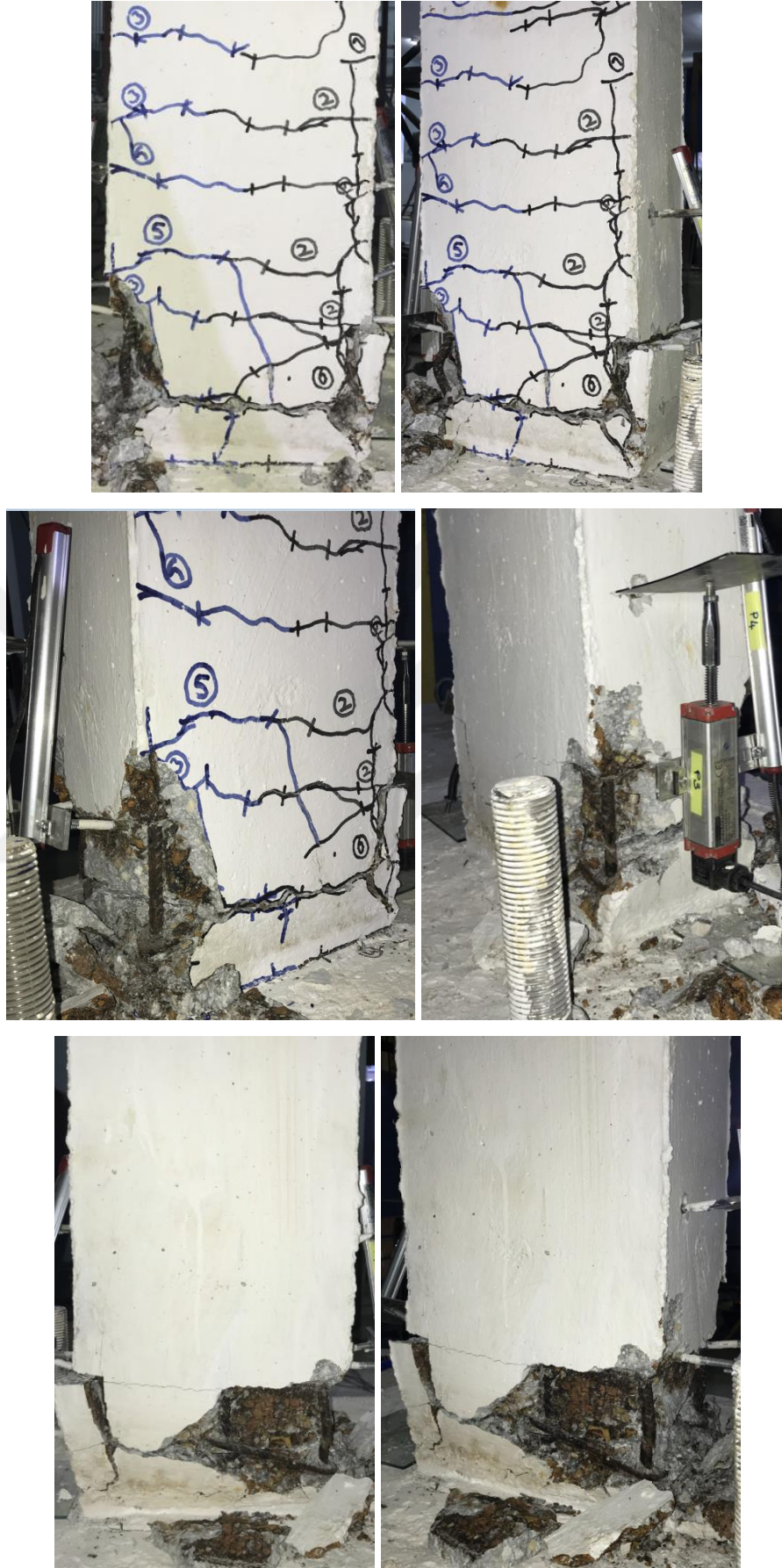
Şekil 4.102. YFC20-%10 numunesinin deney sonu görünümü (devamı)(plastik mafsalsal bölgesi)
