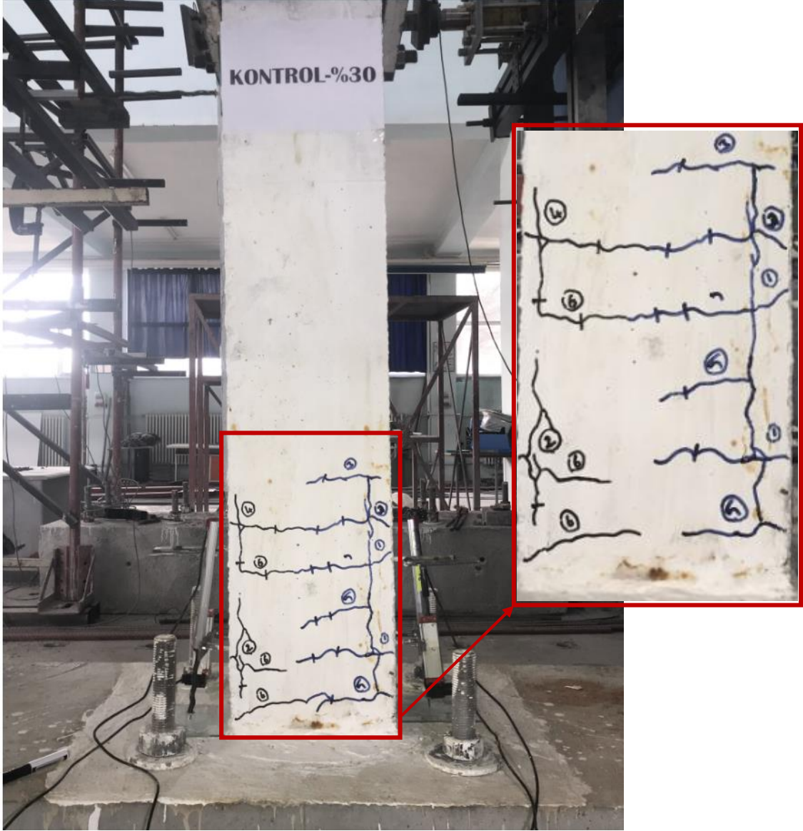
Şekil 4.115. Kontrol-%30 deney numunesinde akma konumunda gözlenen çatlaklar
