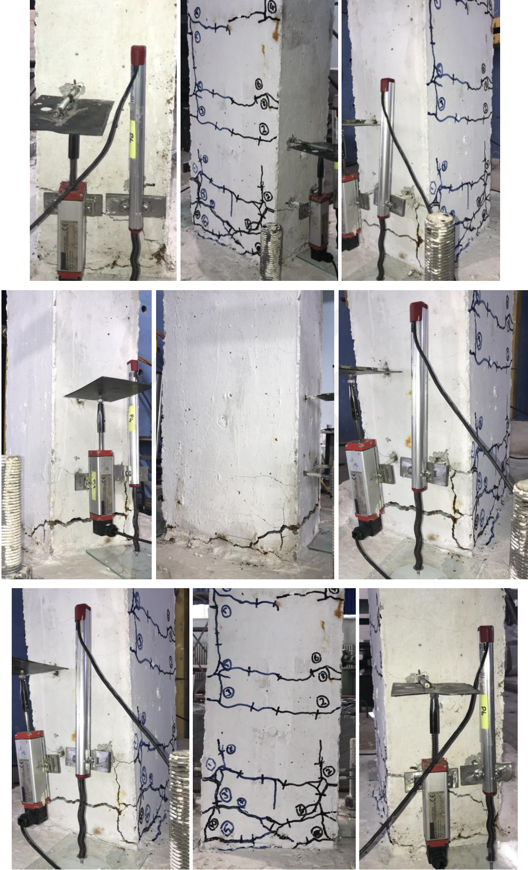
Şekil 4.164. YFC40-%30 numunesinin deney sonu görünümü (devamı)(plastik mafsals bölgesi)
