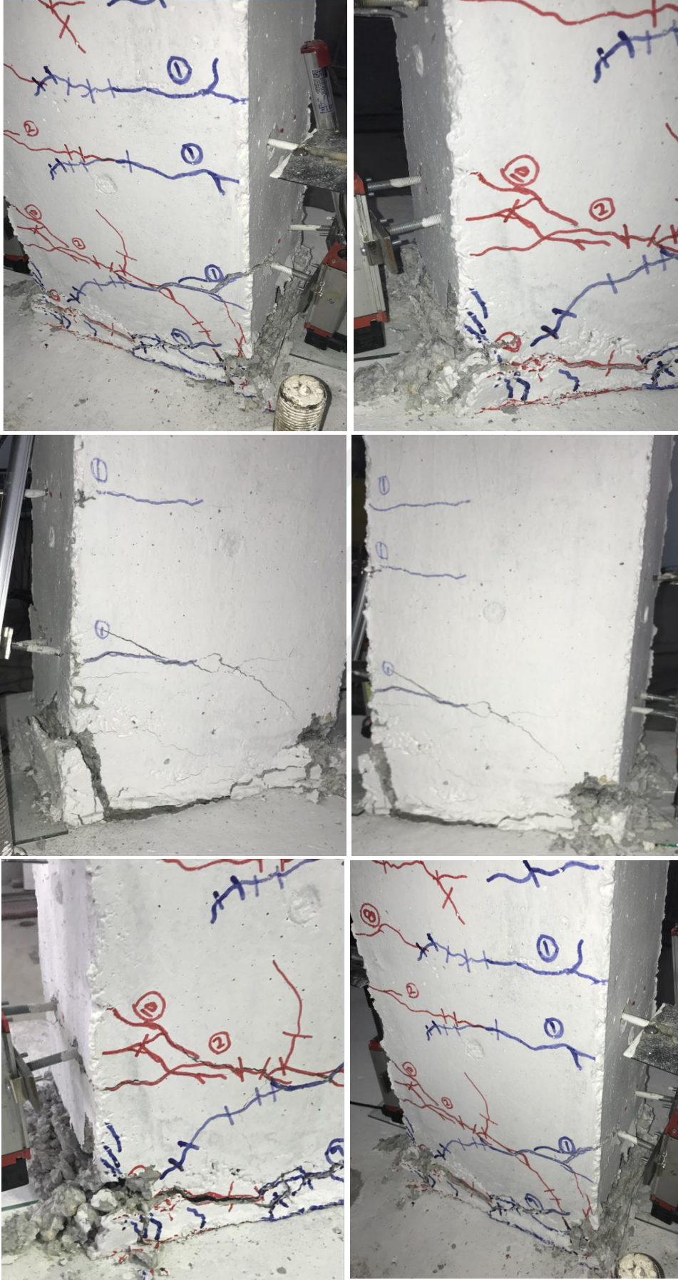
Şekil 4.6. Kontrol-%0 numunesinin deney sonu görünümü (devamı) (plastik mafsalsal bölgesi)
