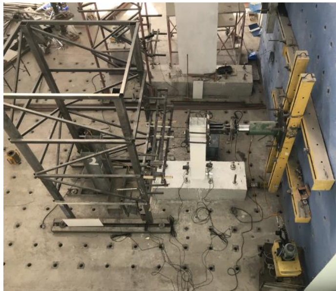
Şekil 3.34. Deneysel eleman yerleştirildikten sonra yükleme sisteminin görünümü
