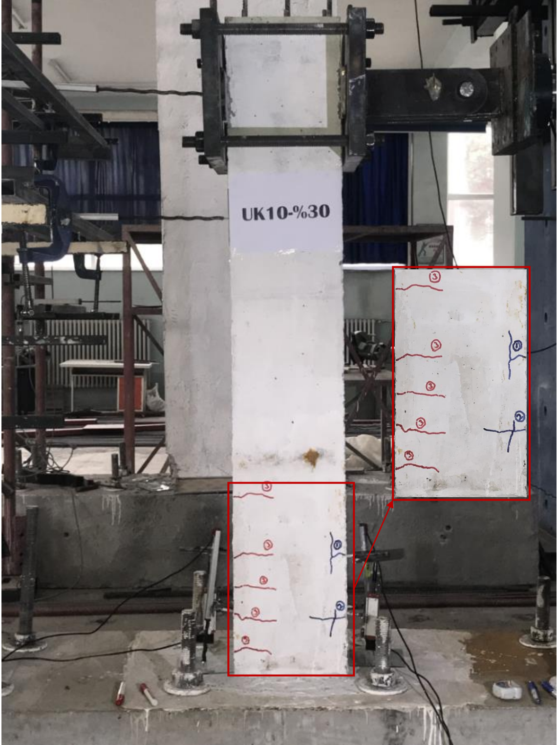
Şekil 4.126. UK10-%30 deney numunesinde oluşan ilk çatlaklar
