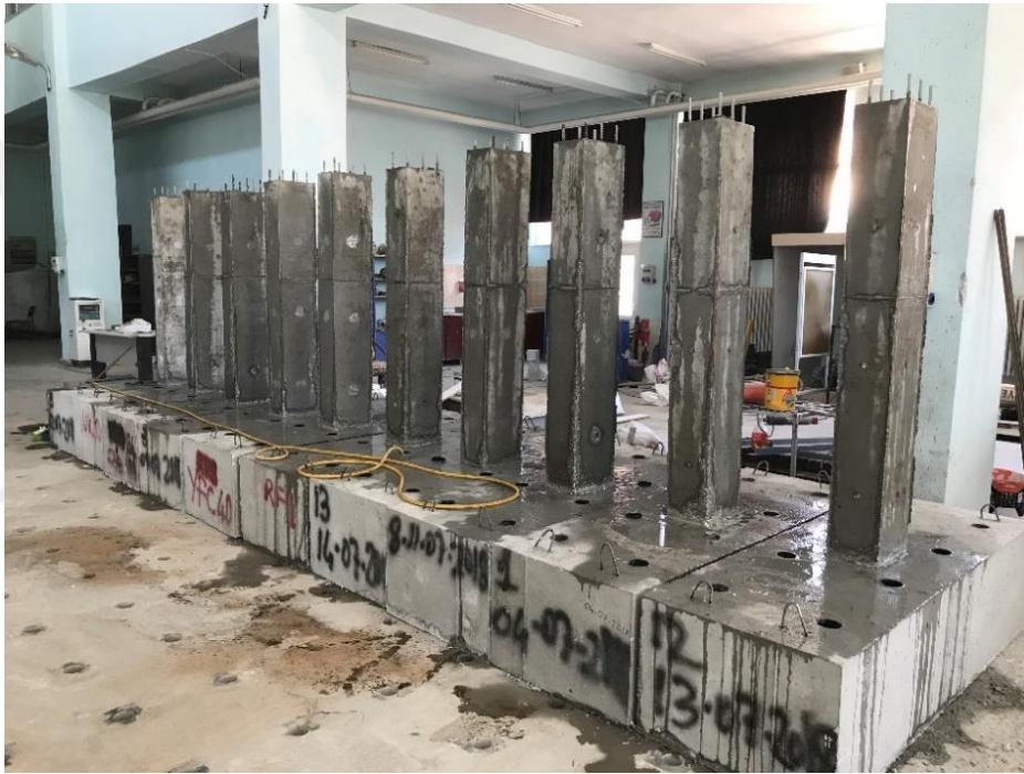
Şekil 3.14. Numunelere laboratuvarda kür işlemi
