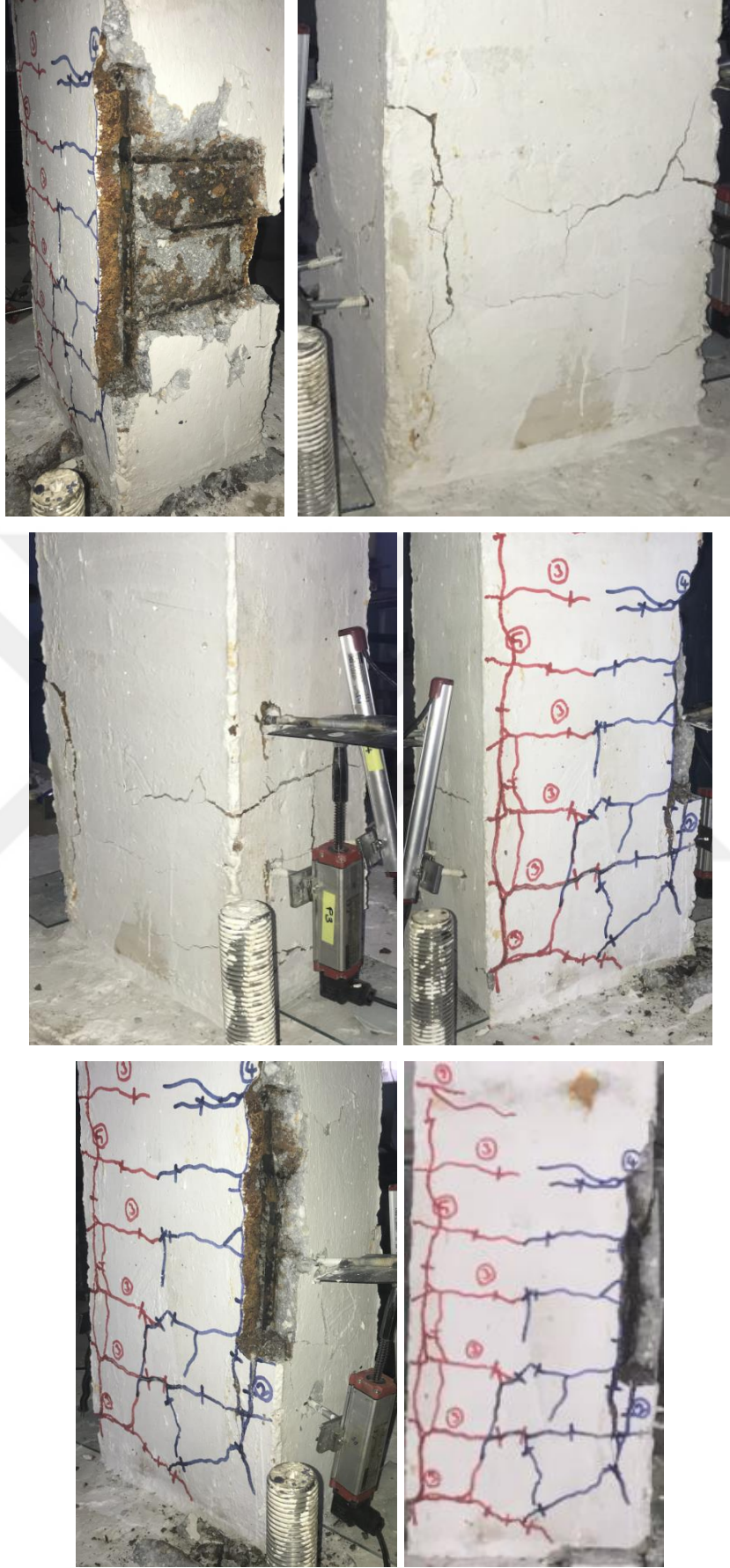
Şekil 4.128. UK10-%30 numunesinin deney sonu görünümü (devamı)(plastik mafsalsal bölgesi)
