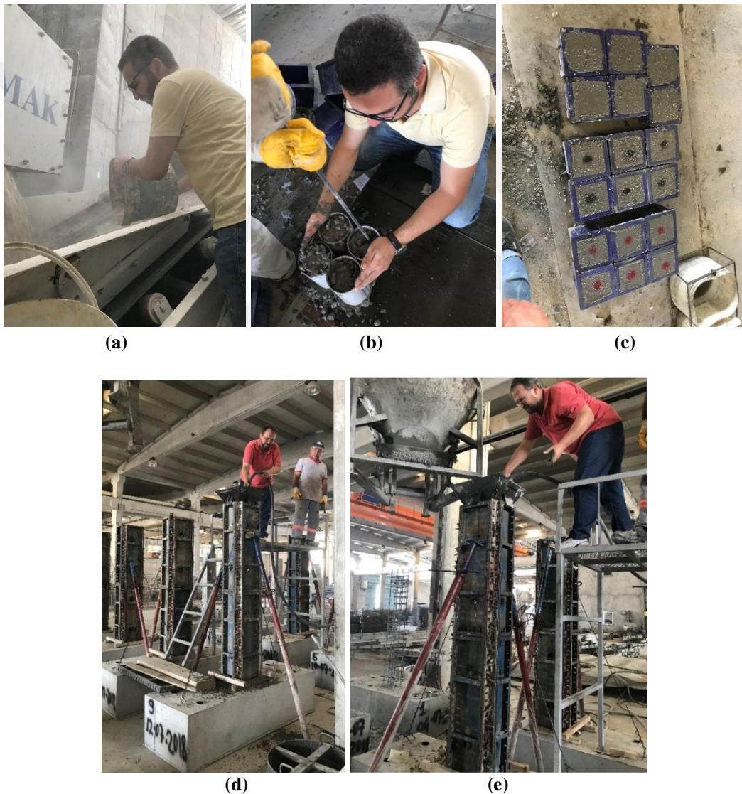
Şekil 3.13. a) Beton karışımlarının hazırlanması b-c) Küp ve silindir numunelerin alımı d-e) Mineral katkı kolonların beton döküm işlemi
