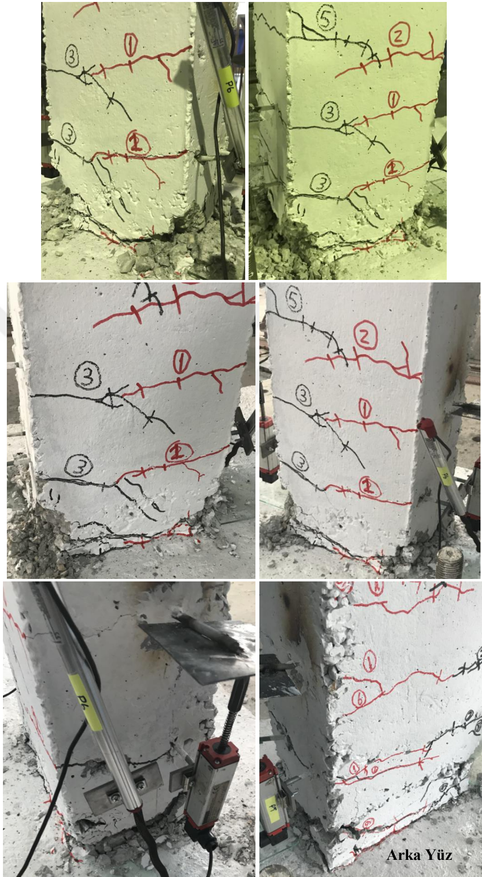
Şekil 4.30. UK20-%0 numunesinin deney sonu görünümü (devamı) (plastik mafsal bölgesi)
