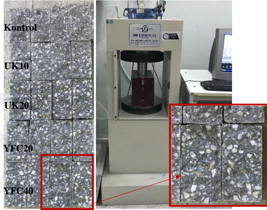
Şekil 3.16. Yarmada-çekme deney cihazı ve deney sonunda numunelerin görünümü
