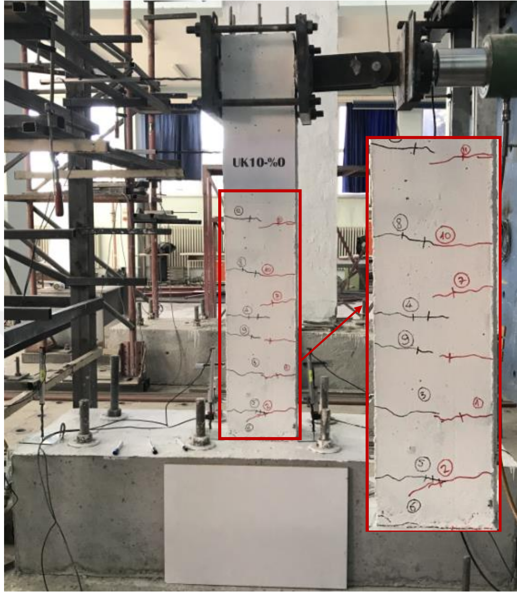
Şekil 4.17. UK10-%0 deney numunesinde akma konumunda gözlenen çatlaklar
