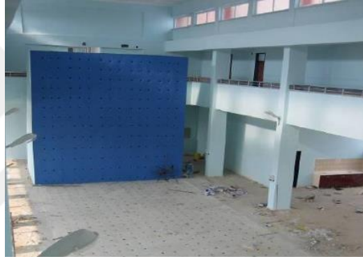
Şekil 3.32. KTÜN İnşaat Müh. Deprem Laboratuvarı'nda bulunan yükleme duvarı ve döşeme sistemi (Akın, 2011)
