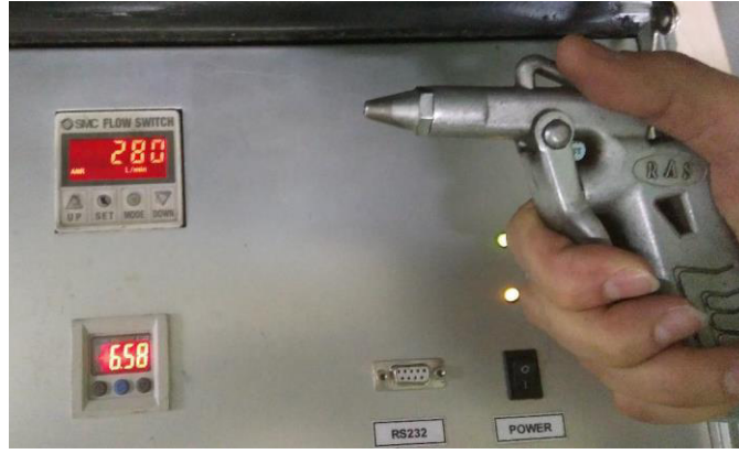
Şekil 4.10. Tesiste standart hava tabancasının hava tüketim miktarı ölçümü
