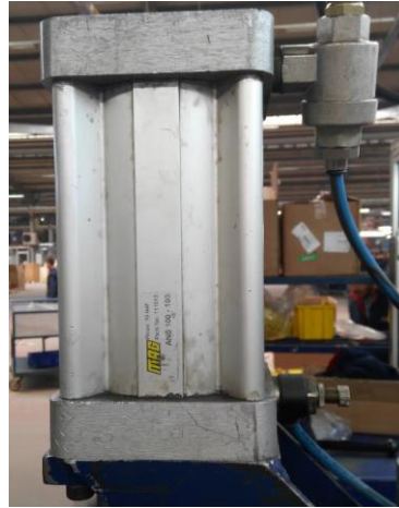
Şekil 4.13. Tek yönde iş yaptıęı gözlenen çift etkili silindir (Ø100-100mm)
