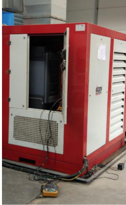
Şekil 4.7. Enerji analizörü ile aktif güç ölçümü
