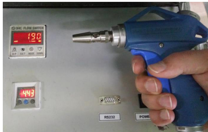
Şekil 4.12. Yüksek verimli hava tabancası ve nozül kullanımında hava tüketim miktarı ölçümü
