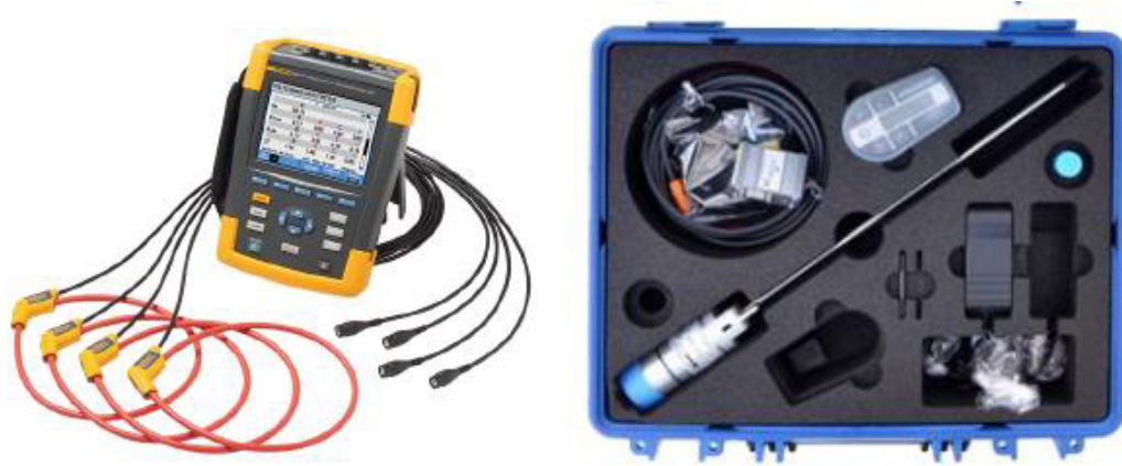
Şekil 4.8. Enerji analizörü (solda) ve hava debimetresi (sağda)
