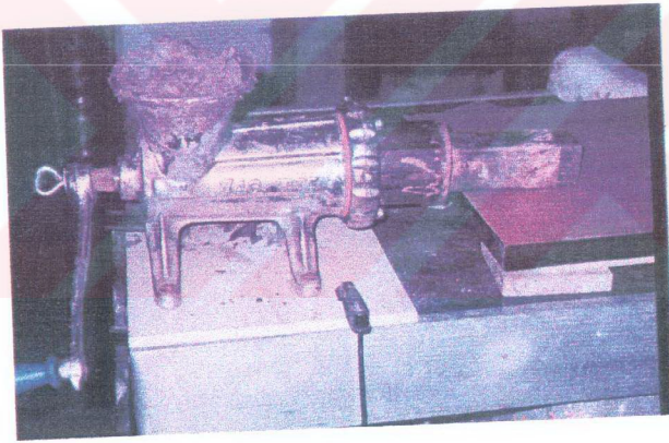
Resim 4.2. Prizmatik Numune Çıkışına Olanak Sağlayan Metal Uç.
