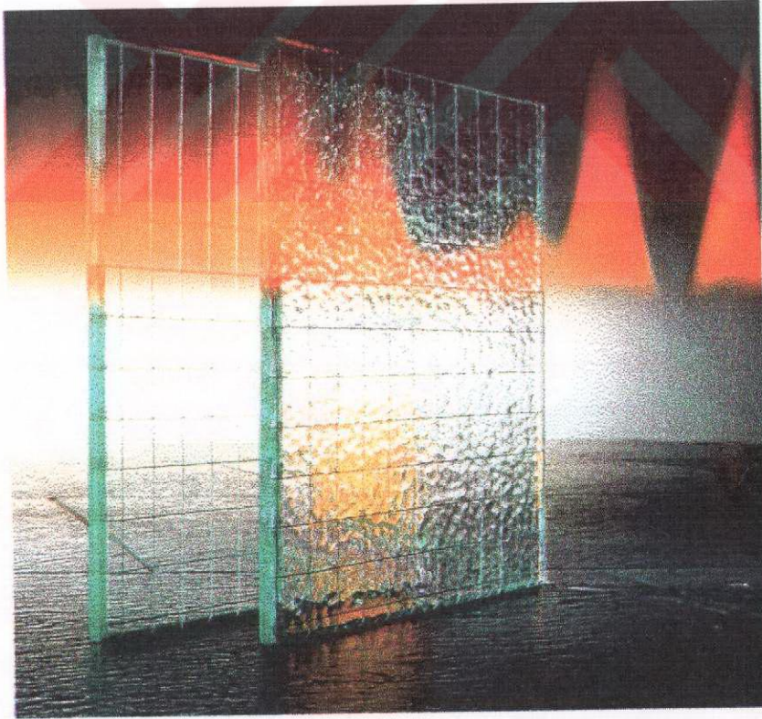
Şekil 2.5. Kullanılan levha cam türünün yüzeysel özelliğine göre adlandırılmış dövme-mandalin ve düz tel örgü ara tabakalı camlar. ( Pilkington , 1996 )
