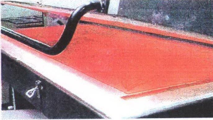
Şekil 2.12. Fırına yerleştirilen kaynak cam ( Desag , 2000 )
