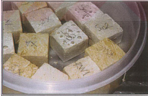
Resim 4.1.7. Suyu Daldırma Metodu Uygulanan Doğal Taş Numunelerde Siloksanın Su-İtici Özelliğinin Devam Etmesi
