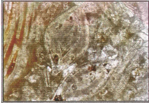
Resim 4.2.3.1.1.3. Siloksan Sürülen Küfeki Taşında Fusilina Kavkuları (Kriptokristalli Kalsitlerden Oluşan Biyomikritik Doku)
