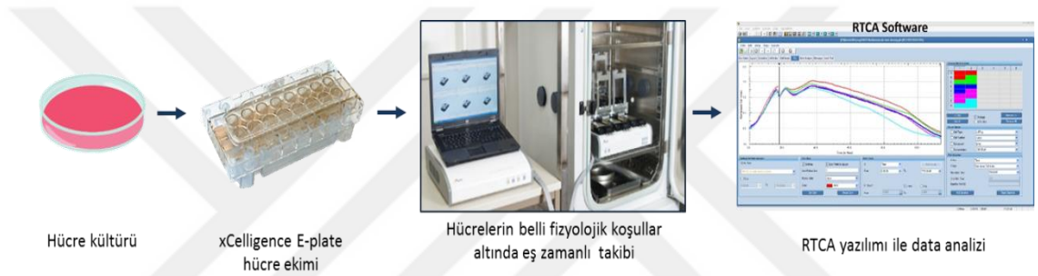
Şekil 8 xCELLigence Sistemi. Hücre canlılığını ve sitotoksiteyi araştırmak için deneysel iş akışı
