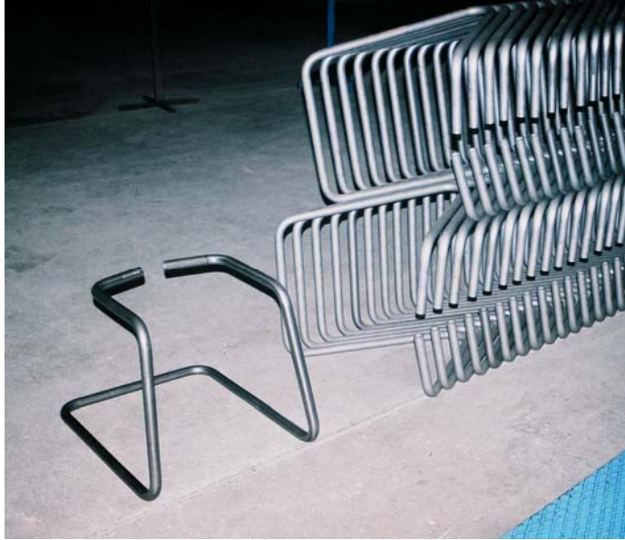
RESİM 3.1. : Programlama sistemi olan boru bükme makinesi ile sandalye iskeletinin hazırlanması, 2003 (Tuna Çelik Fabrikası, foto.: S.Yalçın Usal).
