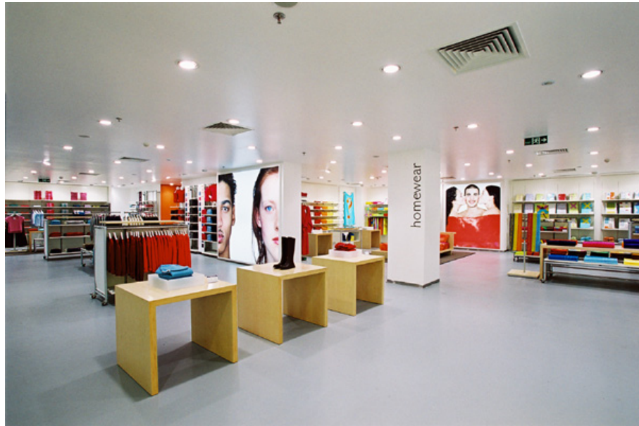
Şekil 3.35. Benetton mağazalarında, Shanghai'daki bu örneğinde de görüldüğü gibi , tavan tasarımlarında sade çözümler getirmektedir. Yüksekliğin elverdiği her mağazasında alçıpan asma tavan ve gömme armatürler kullanırken, alçak tavanlı mekanlarında herhangi bir tavan uygulaması yapmadan sıva üstü spotlar kullanılmaktadır. ( www.benetton.com )
