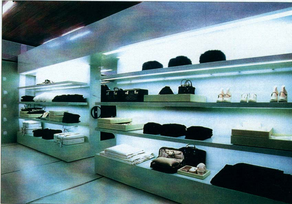
Şekil 3.44. Rem Koolhaas'ın tasarladığı Prada, New York mağazasında sergileme aydınlatması olarak, raflara floresan destekli ikincil aydınlatma sistemleri uygulanmıştır. (Martin Pegler, Stores of the Year, Visual Reference Publications, New York, 2003, s.10. )
