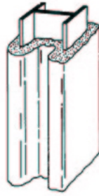
Şekil 12 Çelik Taşıyıcı Elemanların Püskürme Sıvalarla Korunumu[53,s82-84]
