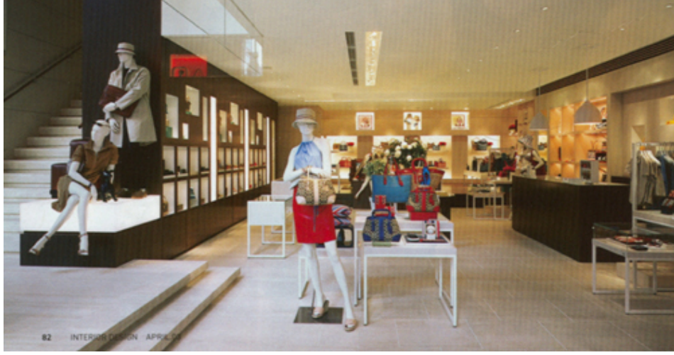
Resim 3. 50. Michael Neumann'ın tasarladığı Japonya'daki Coach mağazasında, merdivenin yanında oluşturulan blok bölücü doğal görünümlü yapay ahşap malzemelerle oluşturulmuştur. Arada bırakılan boşluklar aydınlatılarak teşhir olarak kullanılmıştır (İnterior Design, April 2003, s.82).
