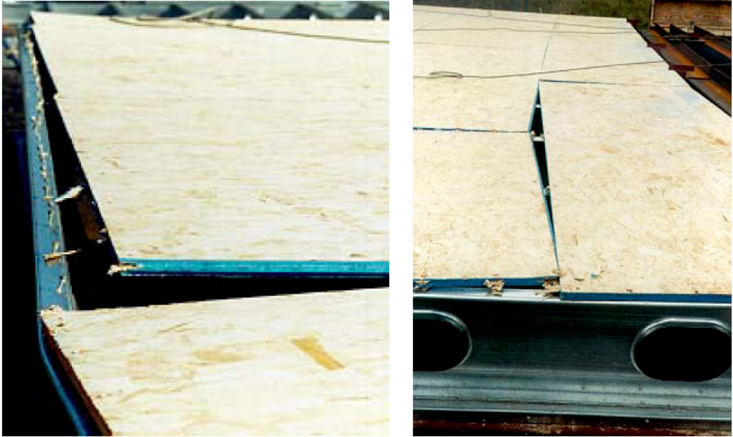
Şekil 3-31 (a-b) Yanal yükleme altında döşeme deformasyonları [53]
