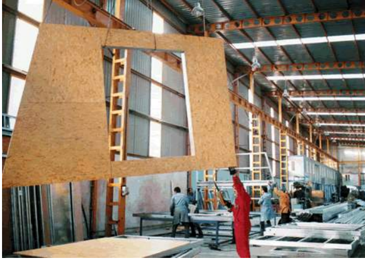
Şekil 2-83 Her iki yüzeyi OSB kaplanmış pano yapım sistemi elemanı [143]
