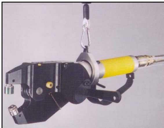
Şekil 2-17 Hidrolik veya hava kompresi ile çalışan punto aleti [55]
