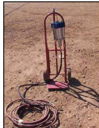
Şekil 2-17 Hidrolik veya hava kompresi ile çalışan punto aleti [55]
