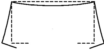
Şekil 3-8 Profillerde aksenal basınç etkisi ile oluşan deformasyon [102]
