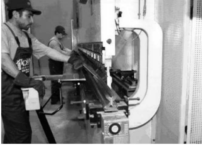
Şekil 2-3 Çelik levhanın bükülerek soğuk şekillendirilmesi. [143]
