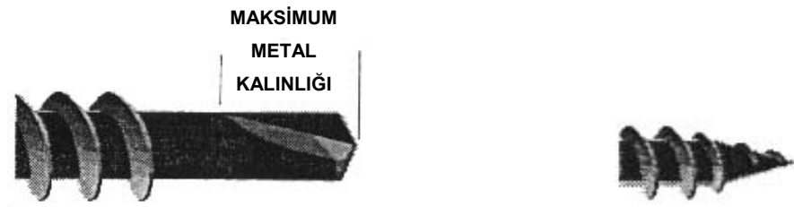
Şekil 2-8 Kendinden delme özelliği olan vida ve 0.88 mm'den ince kalınlıklarda kullanılabilen vida [67]
