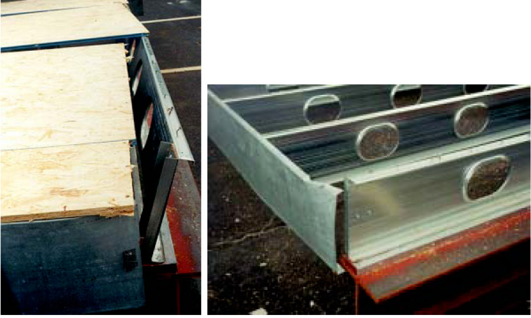
Şekil 3-32 (a-b) Yanal yükleme altında döşeme deformasyonları [53]
