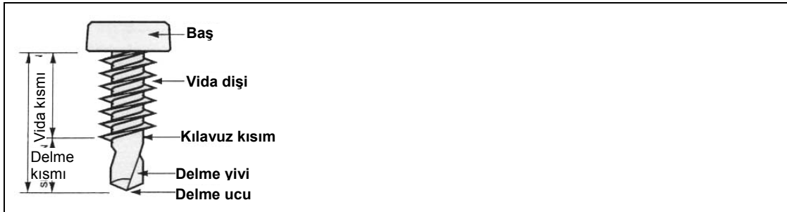
Şekil 2-12 Sadece çelik-çelik tespitinde kullanılan vidalar [67]
