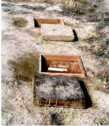
Resim 3.22. 65 Kalıp kerpiç hazırlama
