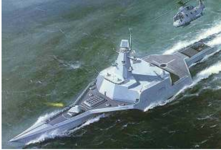
Resim 2. 22: Birleşik Krallık (Büyük Britanya) Deniz Kuvvetleri'ne ait trimaran gövdeli 98m tam boyundaki firkateyn Triton'un perspektifi.
