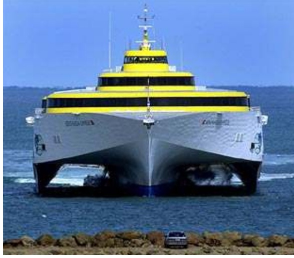
Resim 4. 31: Trimaran karinasıyla 127m boyundaki Benchijigua Express, alüminyum malzemeden inşa edilmiş en büyük deniz aracıdır.
