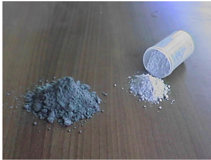
Fotoğraf 4.12: Solda Pirinç Çeltiği Kabuk Külü (%95 SiO 2 ) ve Sağda Saflaştırılmış Hali (%99.6 SiO 2 )
