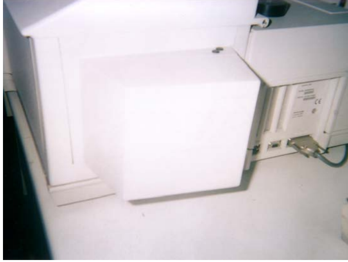
Fotoğraf 4.24: Perkin Elmer marka spektrometre deney aletinin yansıtma deneyi aparatı
