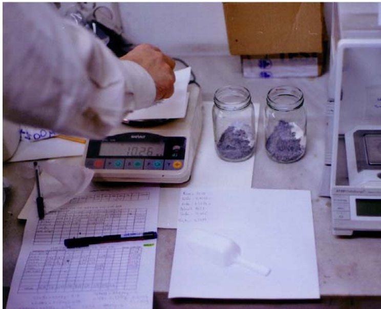
Fotoğraf 4.01: Pirinç Çeltiği Kabuk Külü düz cam kompozisyonu hazırlığının tartım aşaması
