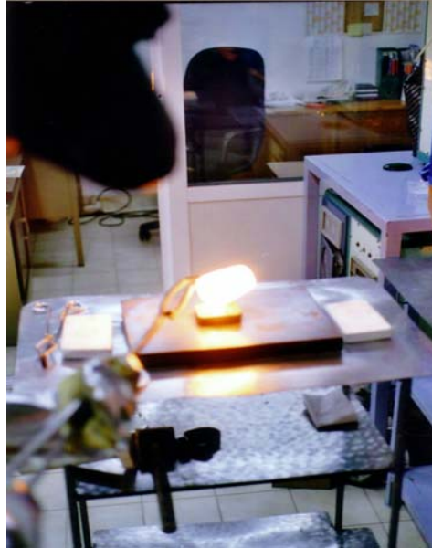
Fotoğraf 4.03: Eriyik döküldükten sonra tavlamanın üzerine 500°C’deki fırına konulmuştur.
