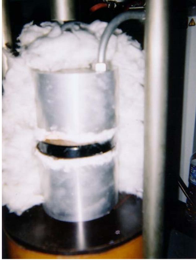
Fotoğraf 4.21: PÇKK camı ve thermocouple sensörleri yerleştirildikten sonra taş yünü yalıtımının uygulanması
