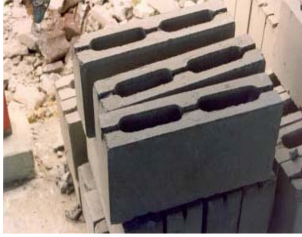
Fotoğraf 1.22 Pirinç eltiđi kabuk klnden bořluklu blok yapımı [2]
