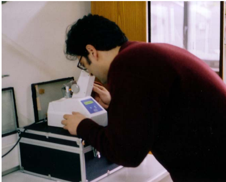
Fotoğraf 4.22: Krüss Optronic marka refraktometre aletinde kırılma indisinin bulunması
