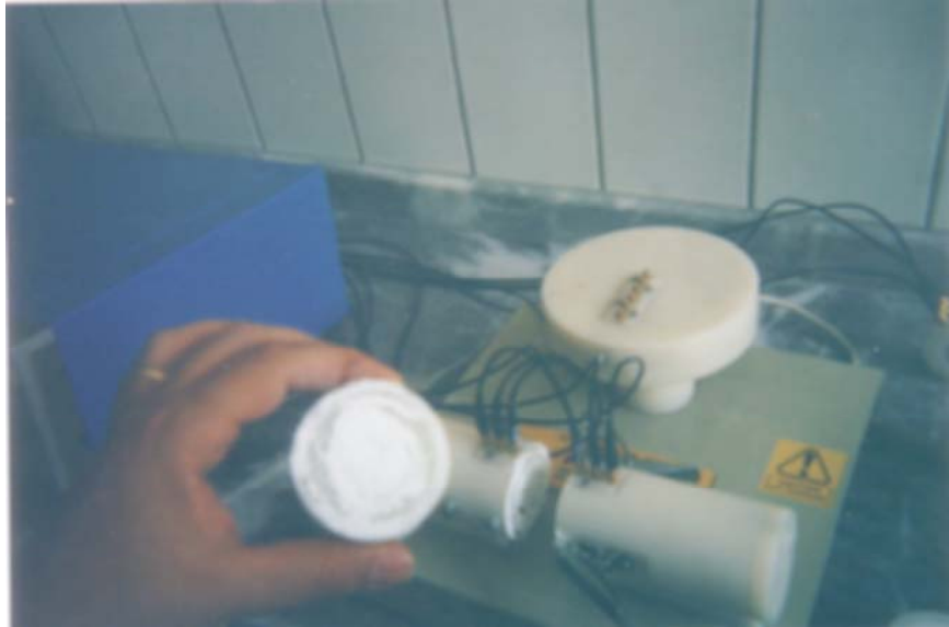
Fotoğraf 4.16: Silindirik dökülmüş PÇKK Camının deney aleti aparatına yerleştirilmesinden sonra macunla sıvanmıştır.
