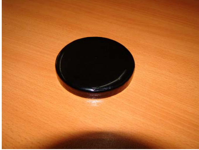
Fotoğraf 4.18: 11 cm çapında hazırlanan PÇÇK camı
