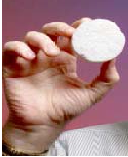
Fotoğraf 1.21: Pirinç Çeltiği Kabuk Külünden ısı yalıtımı işlevi olan levha üretimi [2]
