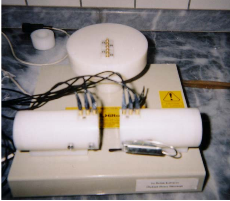
Fotoğraf 4.17: Isıl İletkenlik Deney Aleti ve Termistörleri
