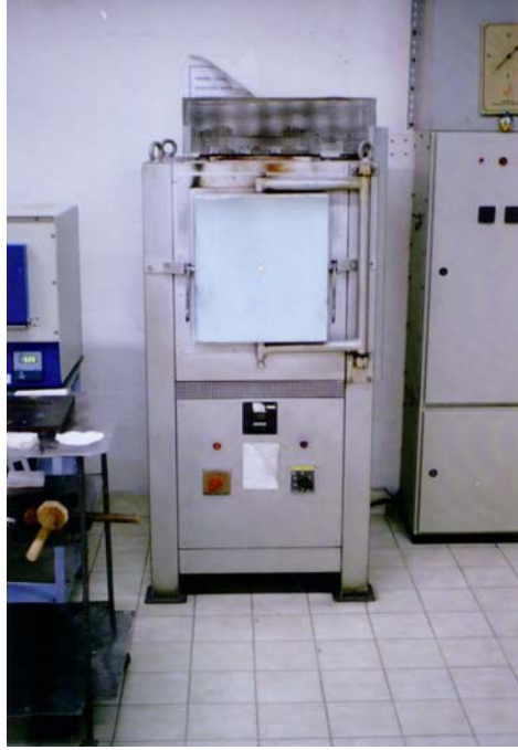
Fotoğraf 4.02: 1400 °C’de Potaya Konan PÇKK Harmanı 4 saat boyunca sabit sıcaklıkta bekletilmiştir. (Şişecam Ar-GE Laboratuvarı)
