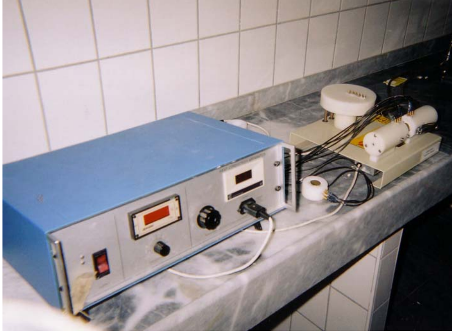
Fotoğraf 4.14: Hilton Marka Isıl İletkenlik Deney Aleti
