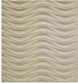
Şekil 3-22 : Hafif pürüzlü, sıva benzeri yüzeyle mineral lif levha, (Mütevellioglu, 1995)
