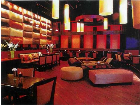
Resim 3-30 : Suede/ Scottsdale- Arizona. Mimar Paul Almond. Kumaş kaplama akustik panellerin mekan içinde bölücü olarak kullanılması
