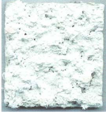
Resim 3-1 : Selüloz ve mineral lifli asbest katkılı malzeme
