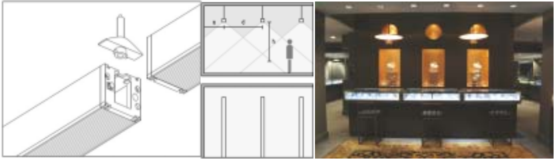
Şekil 2.10 Duvardan uzaklık (a) , iki armatür arası uzaklığın (d) yarısı olmalıdır. İki armatür arası uzaklık (d) ise zemin veya çalışma yüksekliğiyle (h) uyuşmalıdır. Tavana uzaklık, tavan yüzeyinde ne kadar homojenlik istendiğine bağlıdır. Düzgün aydınlatma için tavana olan uzaklık dolaylı aydınlatma için en az 0.8m. olmalıdır.
