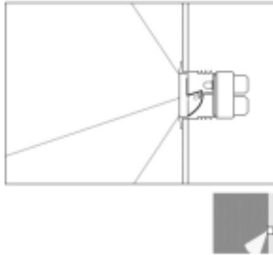
Şekil 2.29 Zemin yıkayan noktasal armatürler duvara monte edilip, zemin yüzeyine yansıtılarak yönlendirir.
