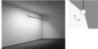
Şekil 2.14 Duvar Yıkayıcı Korniş Armatür Asimetrik ışık yayılımı sağlayarak homojen aydınlatılmış duvar yüzeyleri yaratır.
