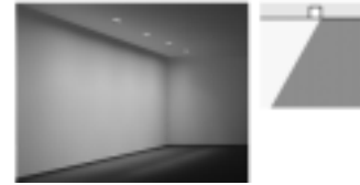
Şekil 2.8 Çift Odaklı Duvar Yıkayıcı: Asimetrik aydınlatma armatürüdür. Lambanın siperi, yüksek görsel konfor sağlar ve fazla ışık yayılımını önler. Işığın homojenliği yüksektir.
