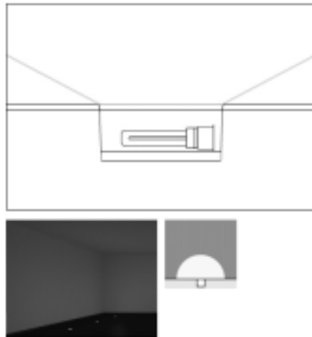
Şekil 2.26 Uplight, yayınlık: Yayınlık ışık veren zemine gömme armatürler, mimari çizgileri vurgulamak ve yürüyüş hatlarını belirginleştirmek amaçlı kullanılır.
