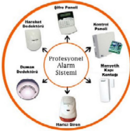
Şekil 5. 4. Alarm Sistemini Oluşturan Parçalar, http://www.teknik-bilisim.com/alarm_sistemleri.html
