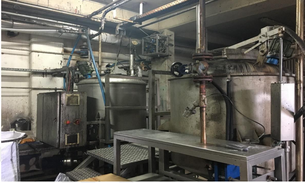
Şekil 14: Boya mutfağında boya hazırlama kazanları
