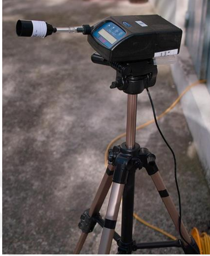
Şekil 28: BUCK Libra Plus™ LP-5 hava rnekleme cihazı [22]
