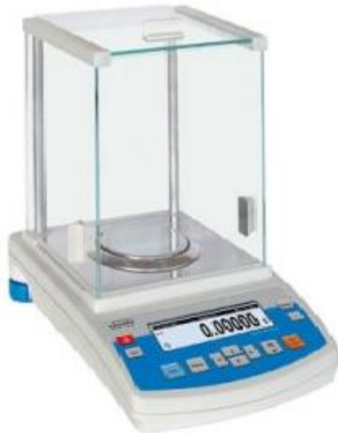
Şekil 29: Radwag AS 60/220 C2 analitik terazi [23]
