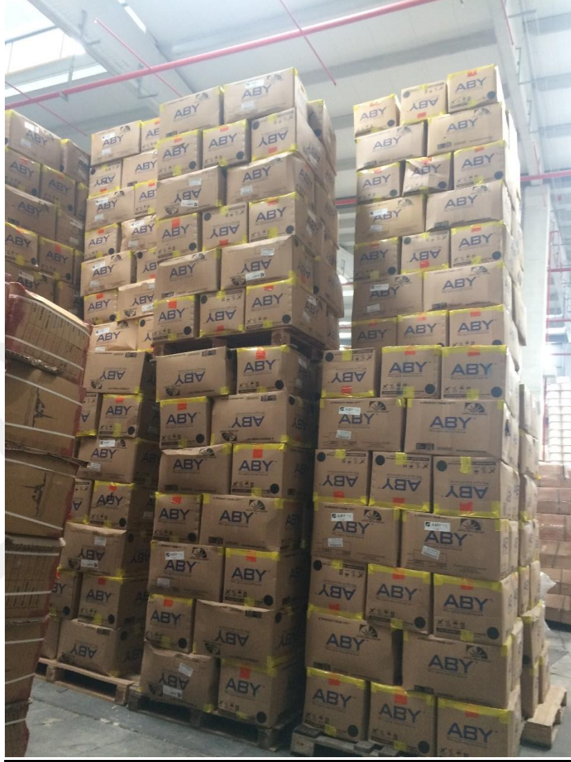
Şekil 26: Depoda bulunan kolilerin devrilme, düşme riski
