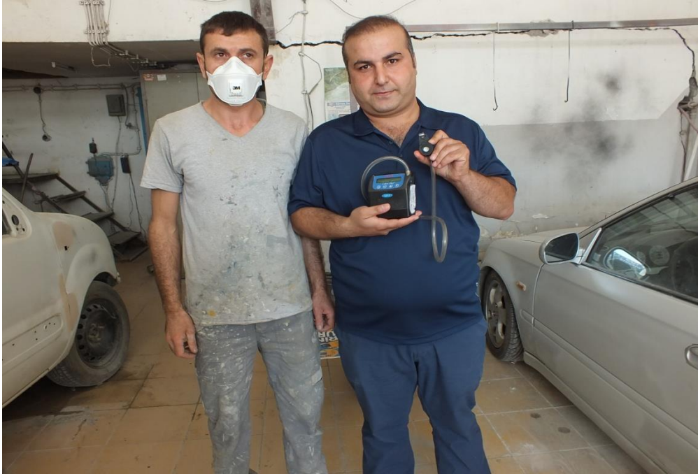
Resim 3. 12. Toplam toz ölçümü için hazır hale getirilen numune alma pompası
