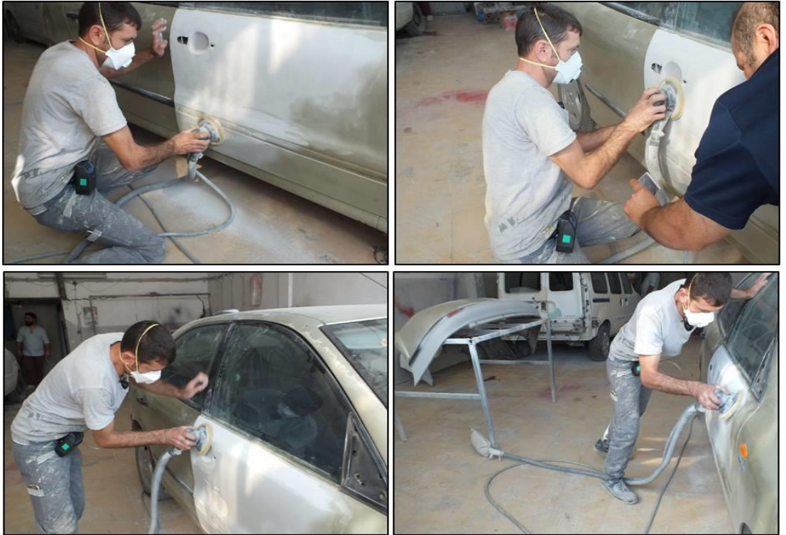
Resim 3. 17. Zımparalama işlemi esnasında örnekleme yapılması
