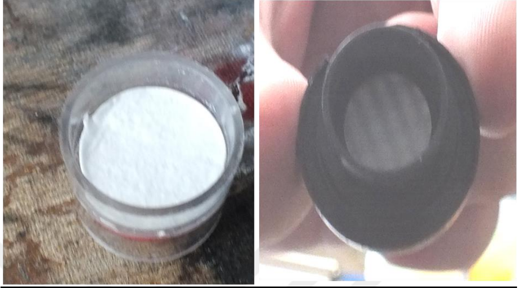
Resim 3. 4. 25 mm apında fiber glass filtre ve filtre kaseti
