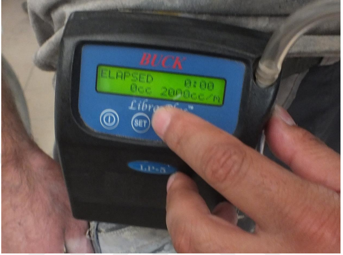
Resim 3. 9. Toplam toz numunesi almak için Buck Libra Plus LP5 marka toz örnekleme pompasının akış hızının 2,0 lt/dk olarak ayarlanması
