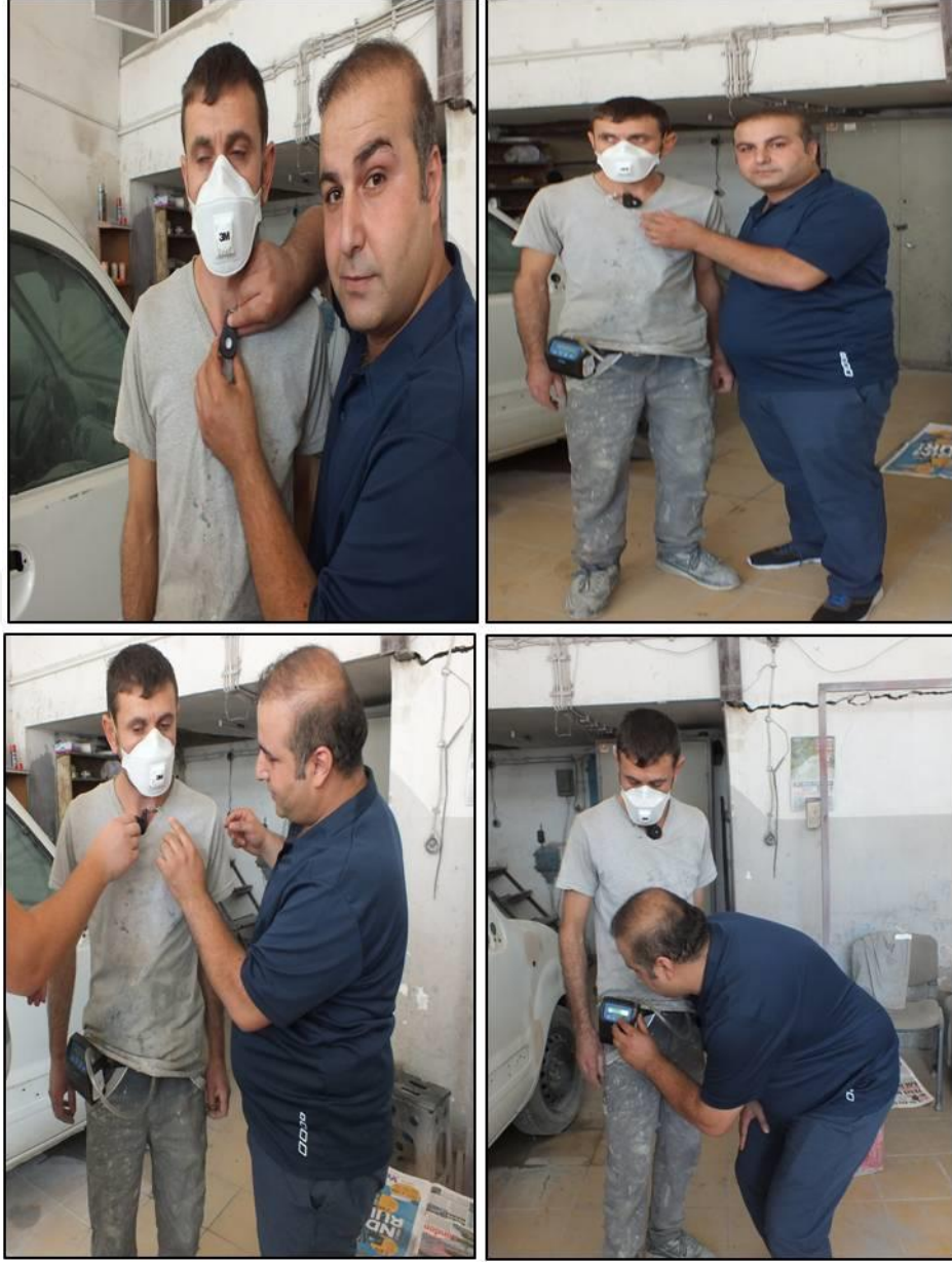
Resim 3. 14. Toplam toz ölçümü yapılan toz pompası ve IOM başlığın konumu
