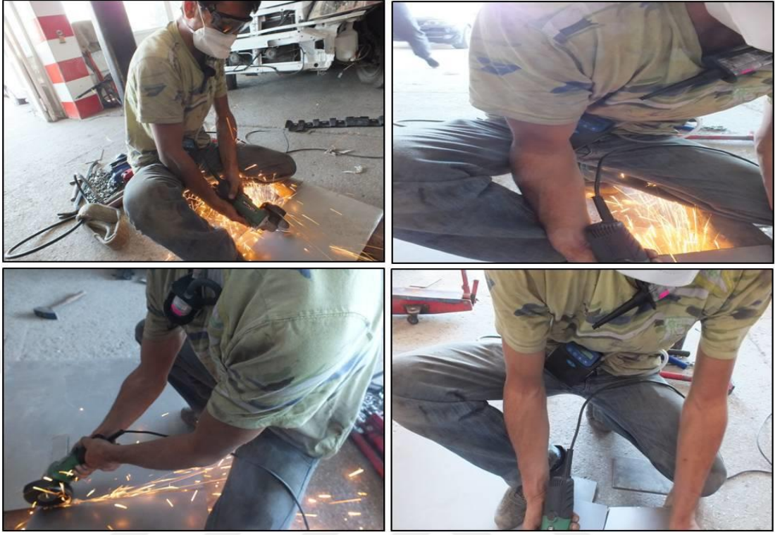
Resim 3. 16. Metal kesme işlemi esnasında örnekleme yapılması
