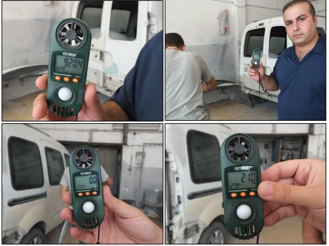
Resim 3. 15. İş ortamı bağıl nem ve sıcaklığının çevresel ölçüm cihazı ile ölçülmesi
