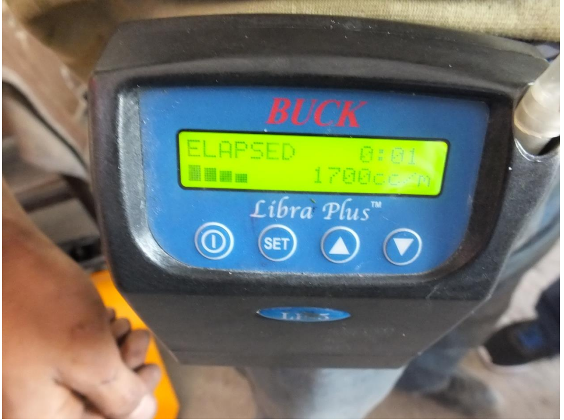
Resim 3. 8. Kişisel solunabilir toz numunesi almak için Buck Libra Plus LP5 marka toz örnekleme pompasının hacimsel akış hızının 1,7 lt/dk olarak ayarlanması
