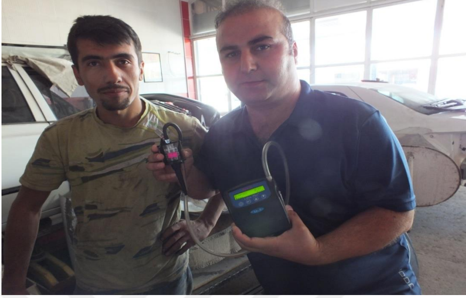
Resim 3. 11. Kişisel solunabilir toz ölçümü için hazır hale getirilen numune alma pompası
