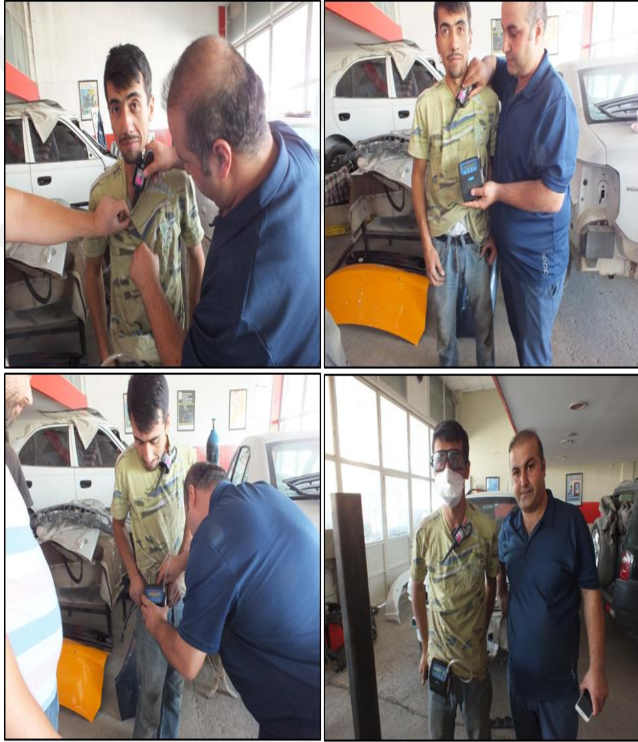
Resim 3. 13. Kiřisel toz lm yapılan toz pompası ve siklon bařlıđın konumu
