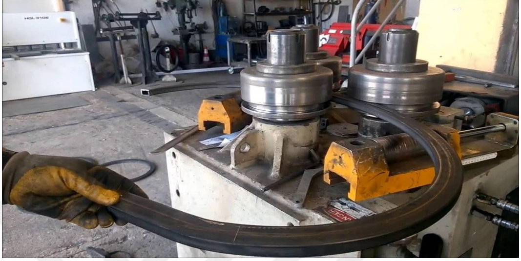
Şekil 8 : Çelik Profil Bükme İşlemi
