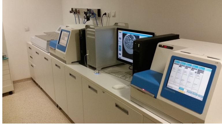
Şekil 3: Dinamik embriyo kültürü amaçlı kullanılan Embriyoskop cihazı
