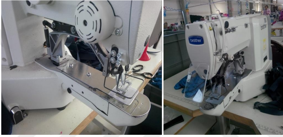
Resim 8. Dikiş makinelerinde iğne kırılmasına karşı kullanılan koruma camı (Öncesi-Sonrası)
