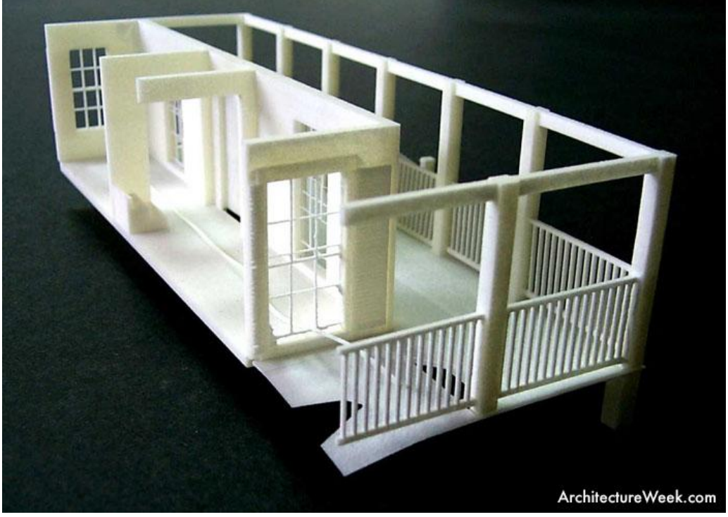
Şekil 2.72 SLS teknolojisi ile üretilmiş mimari proje örneği [1]
