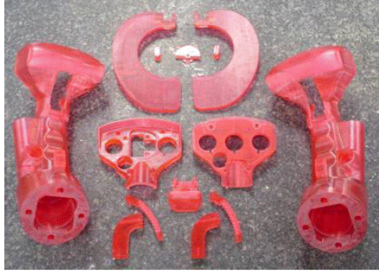
Şekil 2.55 Boeing firmasına ait uçuş simülatorü kontrol kolu parçaları [15]
