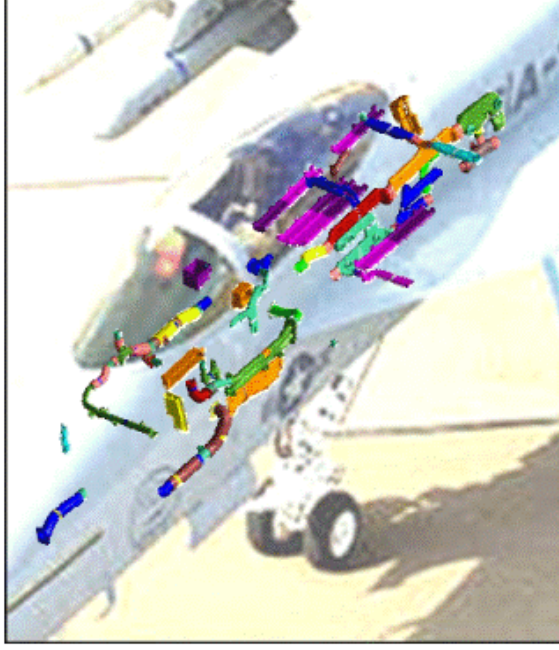
Şekil 2.57 Bir savaş uçağında kullanılan FDM teknolojisi ile üretilmiş parçaları gösteren illüstrasyon [15]
