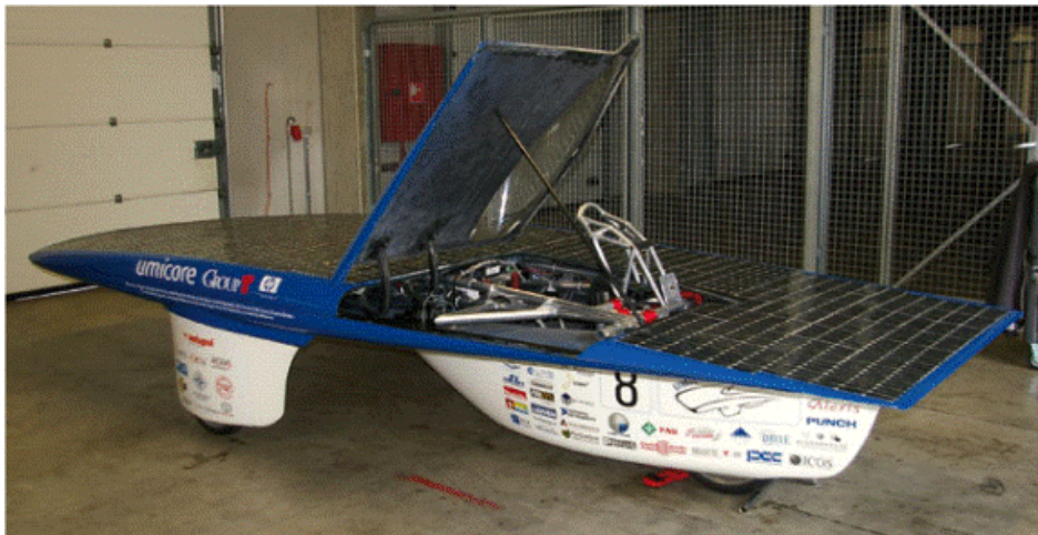
Şekil 2.35 Umicar şirketine ait güneş enerjisi ile çalışan araç [15]
