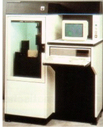
Şekil 2.16 3D Systems firması tarafından ticari olarak sunulan ilk SLA sistem [20]
