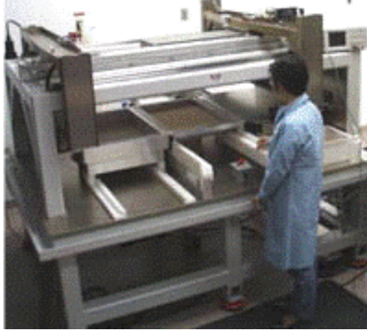
Şekil 2.65-b 3DP tekniği ile çalışan ilaç kapsülleri üretim makinesi [20]
