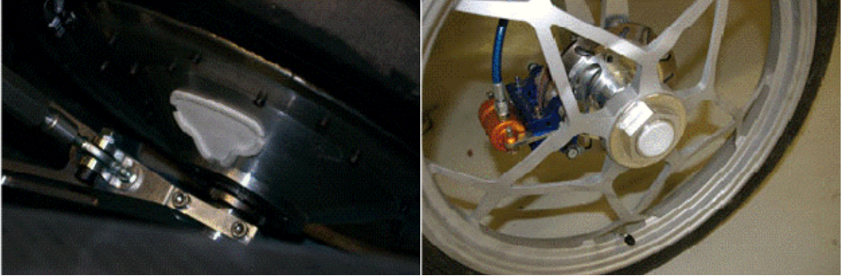
Şekil 2.36 Tekerleklerde kullanılan FDM ile üretilmiş kapaklar [15]
