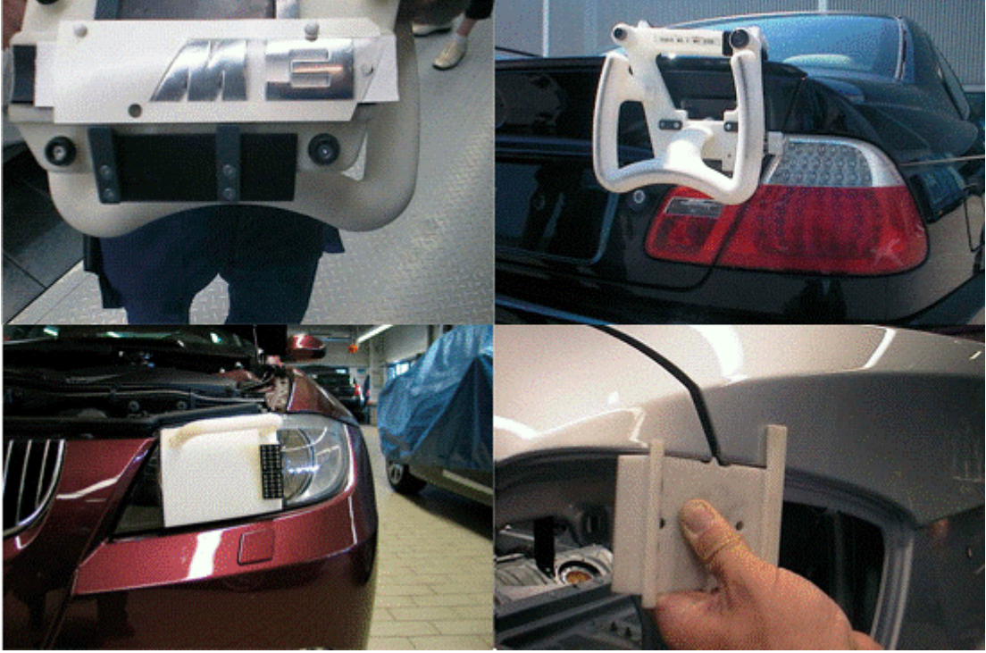
Şekil 2.34 BMW marka araca ait M3 model logosunun, montaj sırasında hızlı ve doğru yere takılabilmesi için üretilmiş bir el aracı [9]
