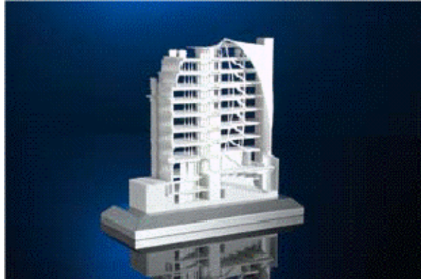
Şekil 2.71 SLS teknolojisi ile üretilmiş mimari proje örneği [15]
