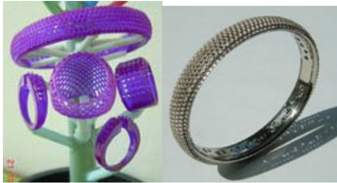
Şekil 2.68 %20 mum içeren malzeme üretilmiş yüzük modelleri mum döküm ağacına bağlanmış hali ve hassas döküm ile elde edilmiş sonuç ürün [20]
