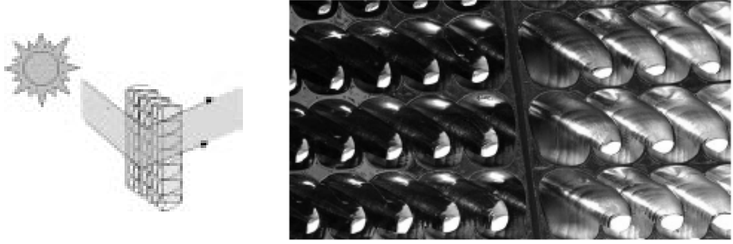
Şekil 5.6. Anidolik petek sisteminin yapısı
