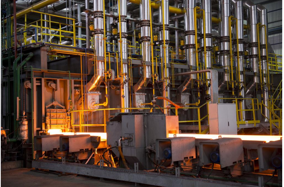
Şekil 6 : Kütüklerin Tav Fırınlarında Tavlansması
