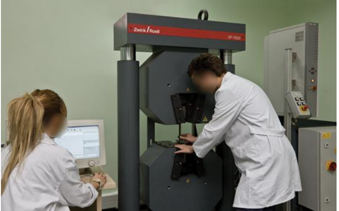
Şekil 11 : Üretilen Çubuk Demirlerin Çekme Testlerinin Yapıldığı Cihaz
