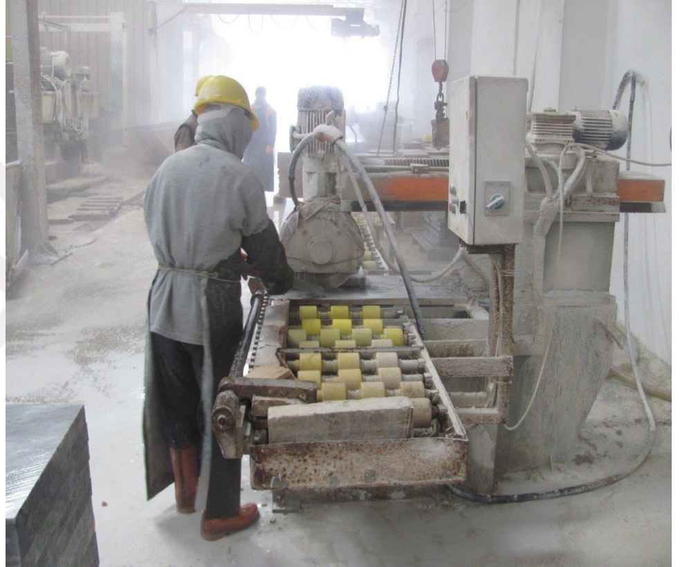
Resim 14: ST bloktan plaka kesim makinesi.
