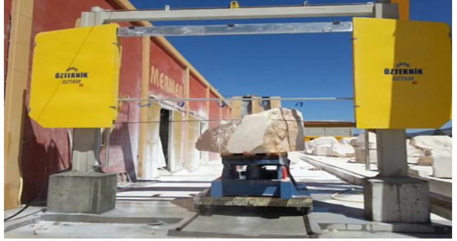
Resim 10: Elmas telli makine ile blok sayalması. (düzeltilmesi)
