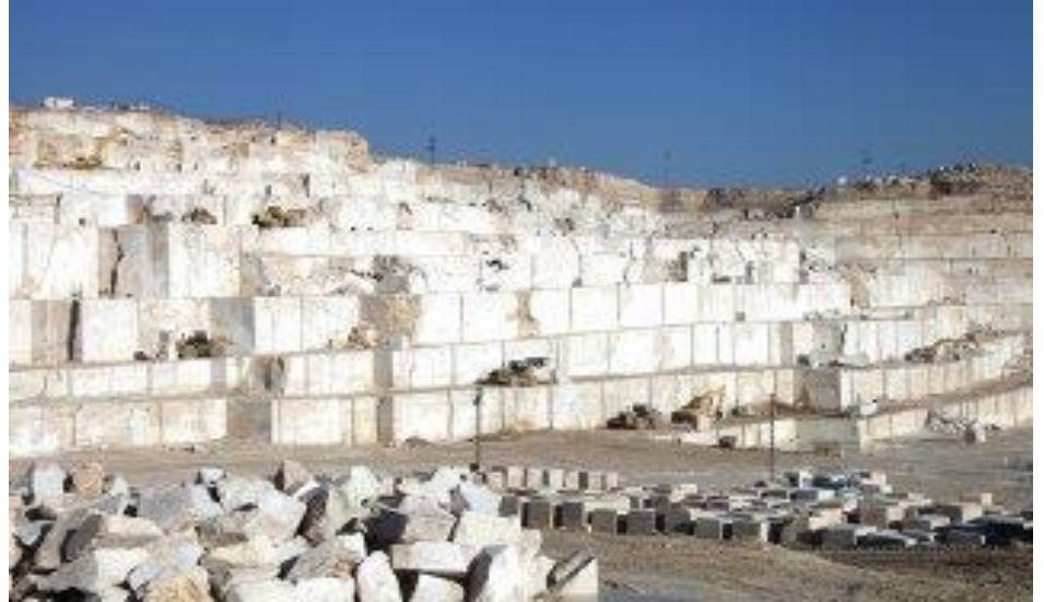
Şekil 11: Tepe Tipi Açık Ocak Doğal Taş İşletmesi (Çakmaklar Mermer)
