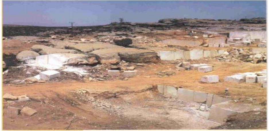
Şekil 5: Tek Kademeli Açık Doğal Taş Ocağı (Demmer Mermer, Afyon)
