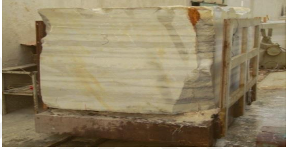
Resim 12: Vagona yerleştirilmiş blok.
