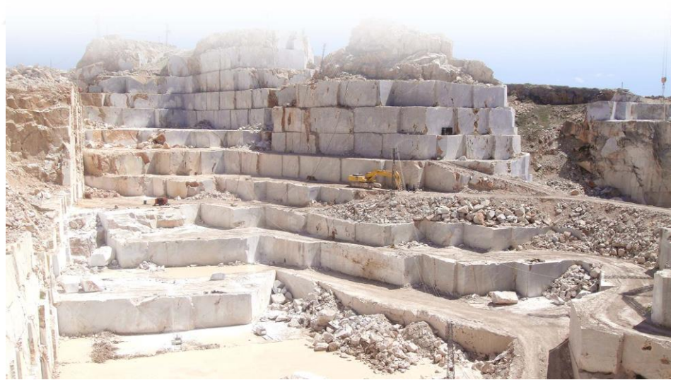
Şekil 13: Yamaç Tipi Açık Ocak Doğal Taş İşletmesi (Alimoğlu Mermer)
