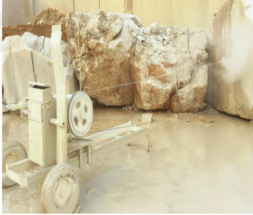
Resim 7: Sayalama yapılışı. (Demmer Maden mermer ocağı)
