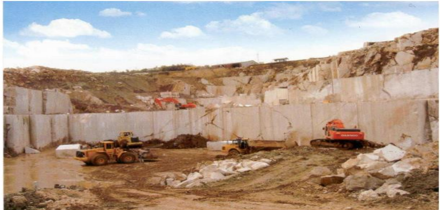
Şekil 8: Ova tipi açık-rampasız doğal taş yatağı (Alimoğlu Mermer) 16
