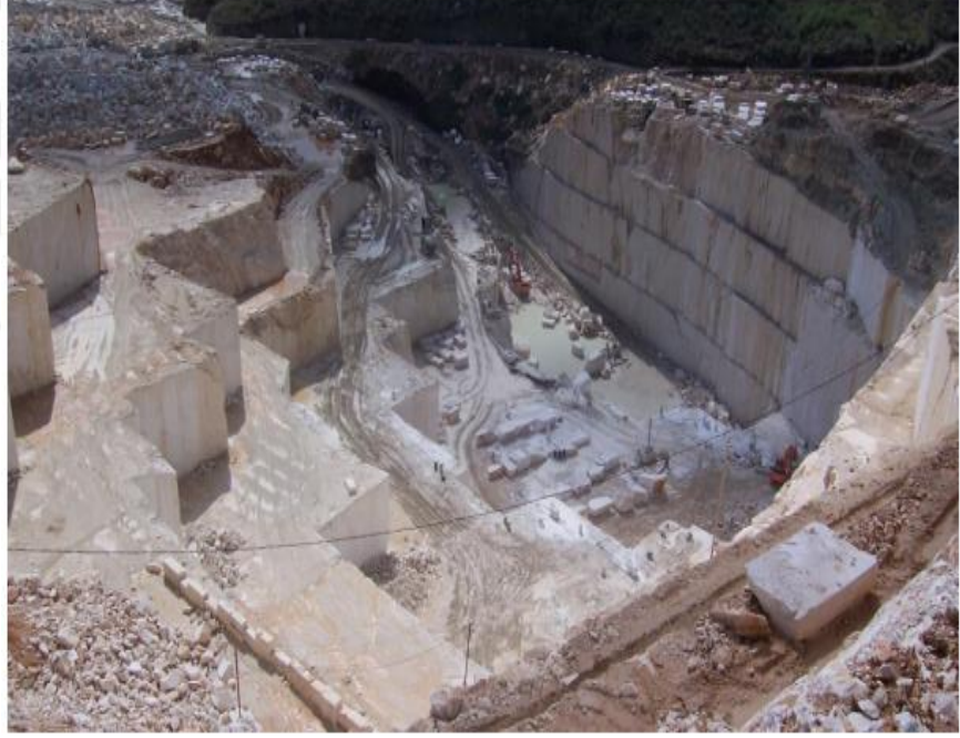
Şekil 2: Yamaç Tipi Bir Doğal Taş Ocağının Üretim Sonucu Ova Tipine Dönüşmesi 15
