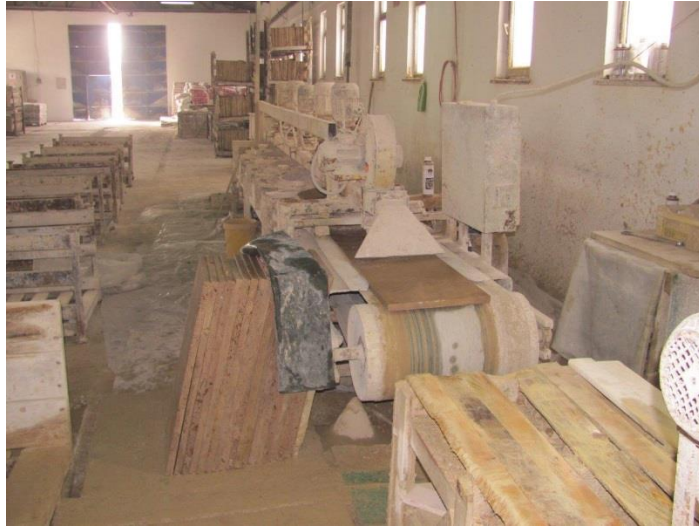
Resim 24: Kalibre işlemi (Demmer Mermer)
