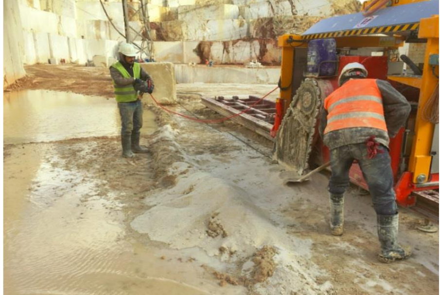
Resim 1: Kollu zincirli kesme makinesi ve kesme işlemi. 'Fantini' (Demmer Maden mermer ocağı)
