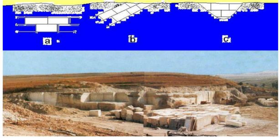
Şekil 7: Ova Tipi Doğal Taş Yataklarına Şematik (A,B,C) Ve Fotoğrafik Örnekler 16
