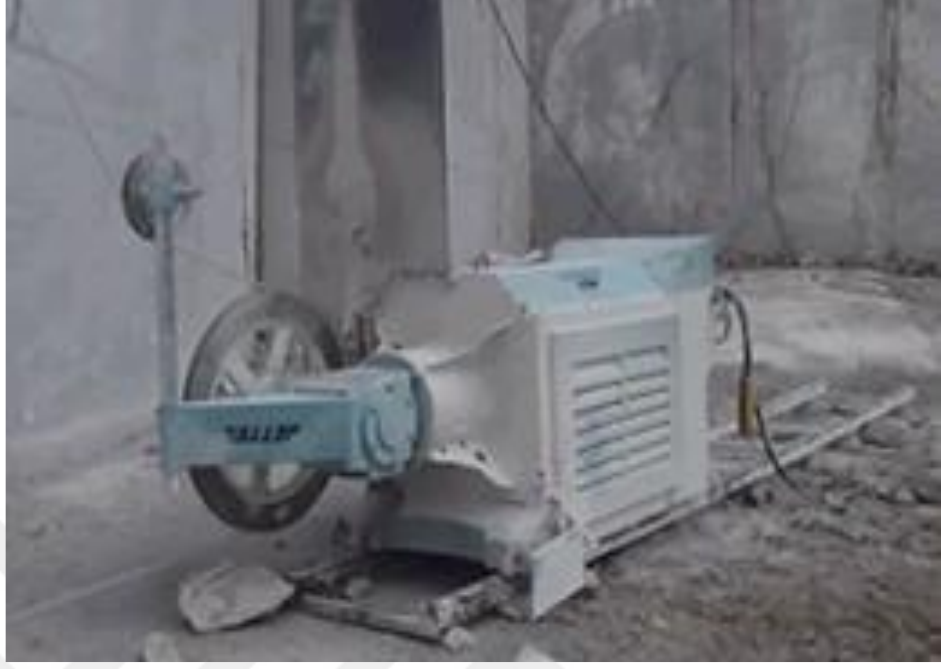
Resim 4: Elmas tel kesme makinası (Demmer Maden mermer ocağı)
