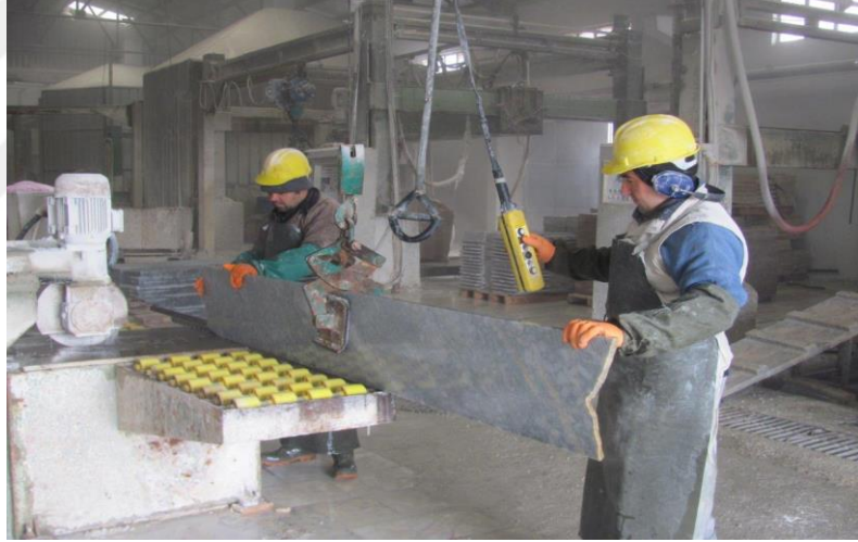
Resim 23: Orta yarma makinesi (Demmer Mermer)
