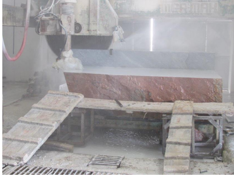
Resim 22: Köprü kesme makinaları. 'Brio- Simec'
