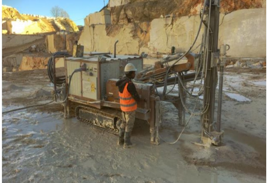
Resim 2: Mermer sondaj makinası ile delme işlemi. Kaptan rock (paletli) (Demmer Maden mermer ocağı)
