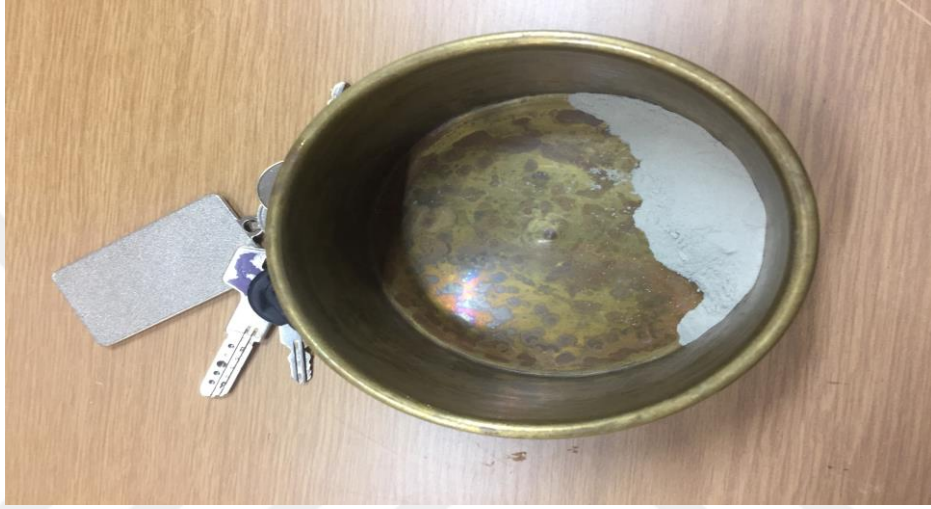
Şekil 10. 170 meş altı toz XRD çekimi için kullanılacak numune
