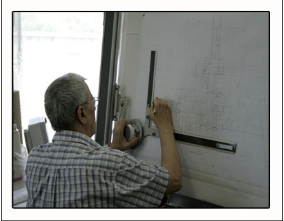
Şekil 5. 1. Dikey çizim masasında geleneksel yöntem ile çizim yapımı.
