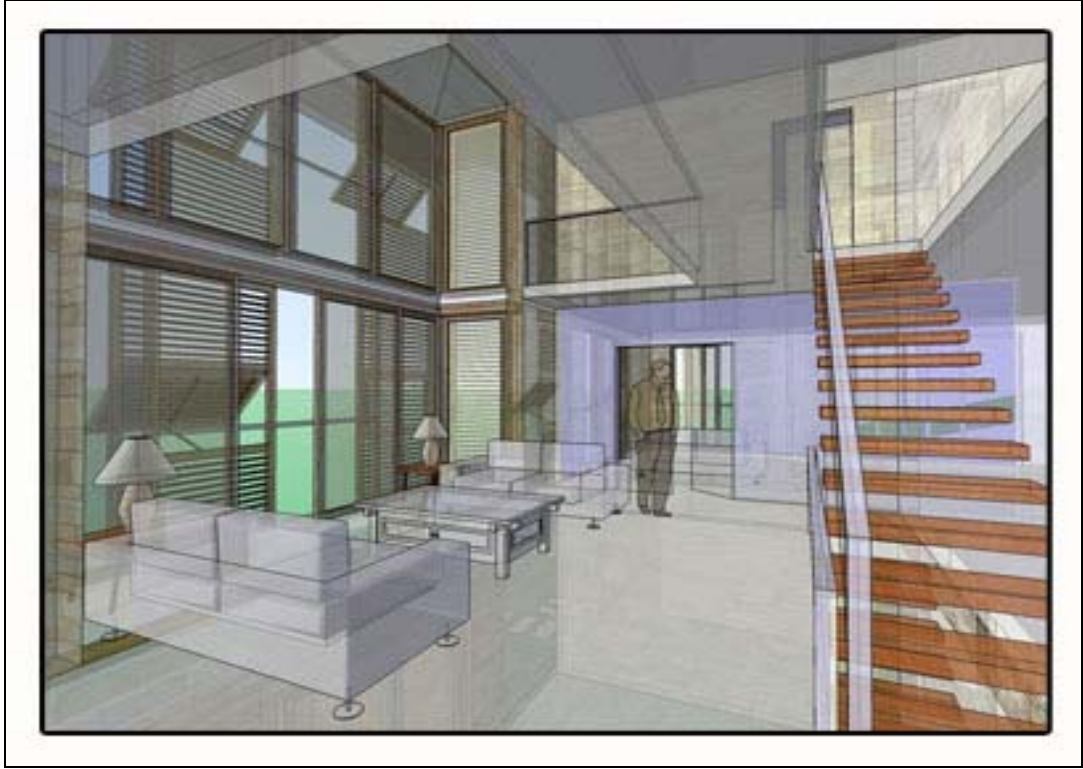
Şekil 5. 7.Tel kafes yöntemi ile oluşturulmuş perspektif çizimi.
