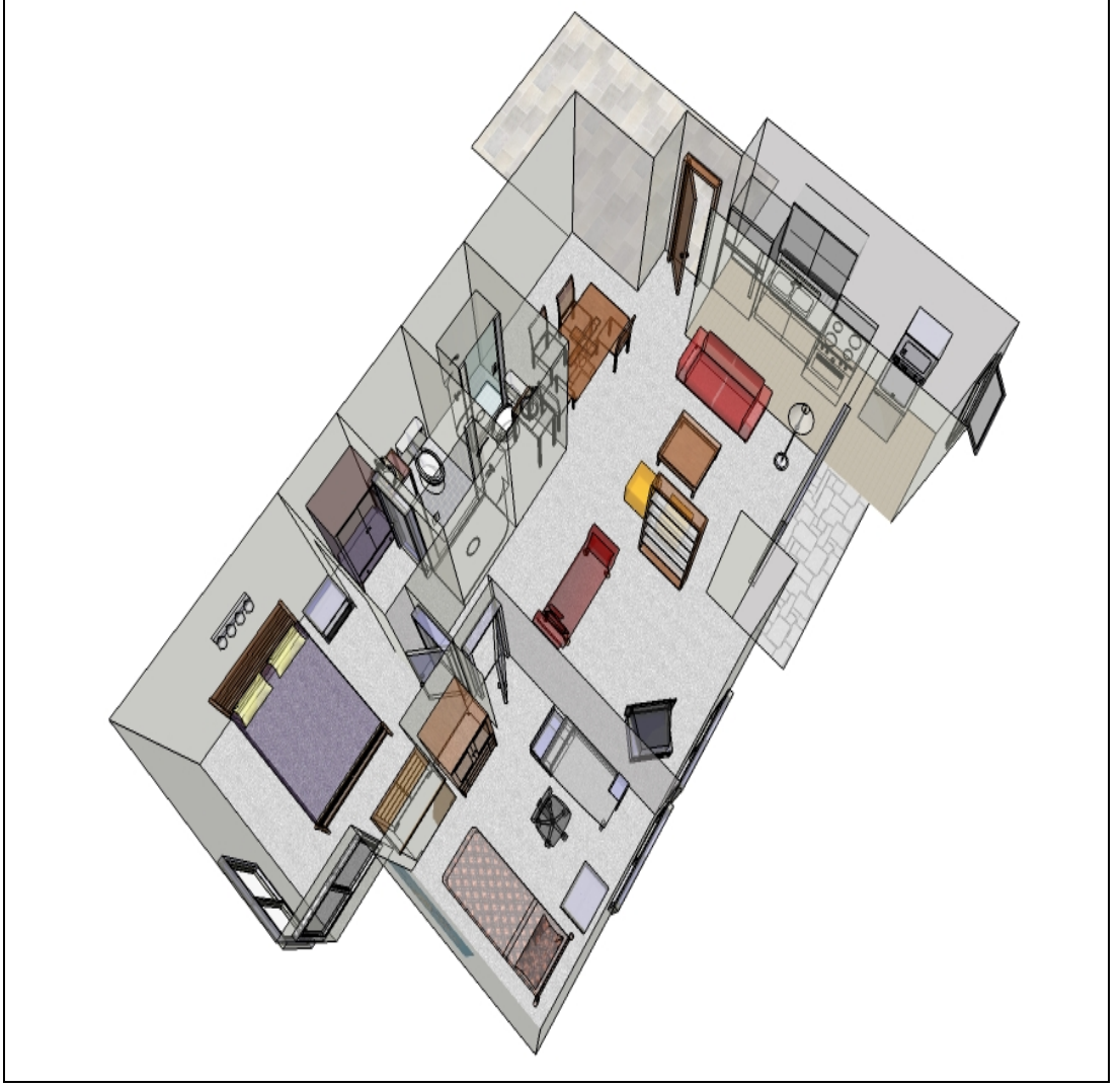
Şekil 5. 9. Tel kafes yöntemi ile bilgisayarda hazırlanmış aksonometrik perspektif sunumu. Bilgisayarlar iç mekân projelerinin sunum aşamasında, projeyi çizen kişiye zaman kazandırırken, projenin uygulama aşamasını da öne çeker. Doğru uygulandığında; detaylı, kaliteli sunum imkânı ile gerçekçi bir anlatım sağlar. (Şekil 5. 9)
