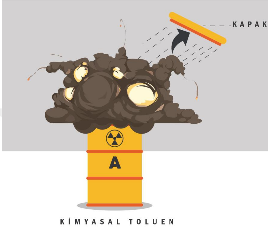
Resim 13 Toluen Tankında Buhar Bulutu Patlaması ve Tank Kapağının Fırlaması
