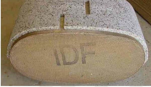
Resim 1 : Katalitik Dönüştürücünün İçindeki Monolit
