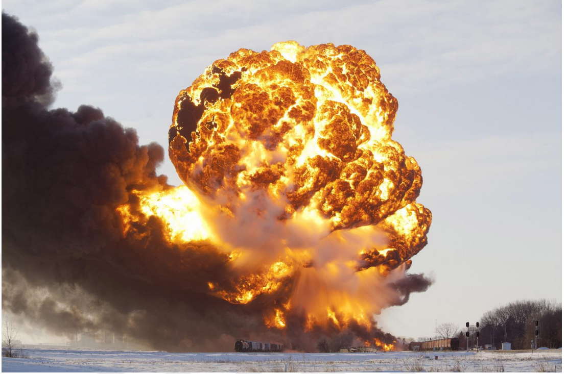
Resim 2. Devrilen LPG Yüklü Tren Vagonunda Bleve Olayı
