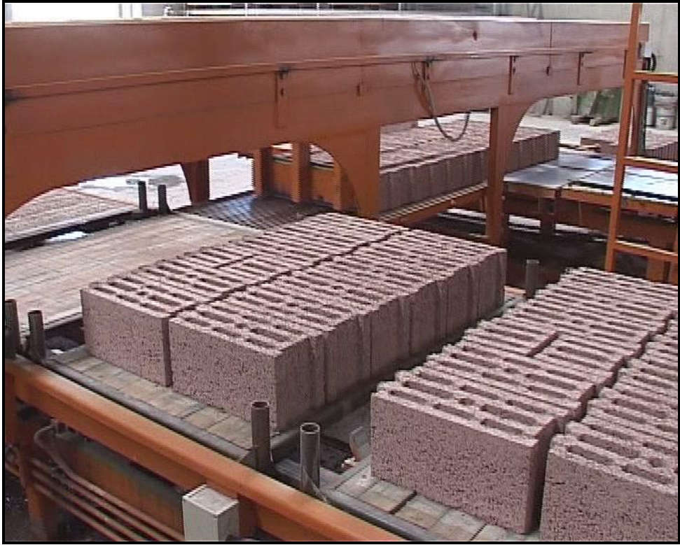
Şekil 3.32 Bimsblokların Üretiminden Bir Görünüm
