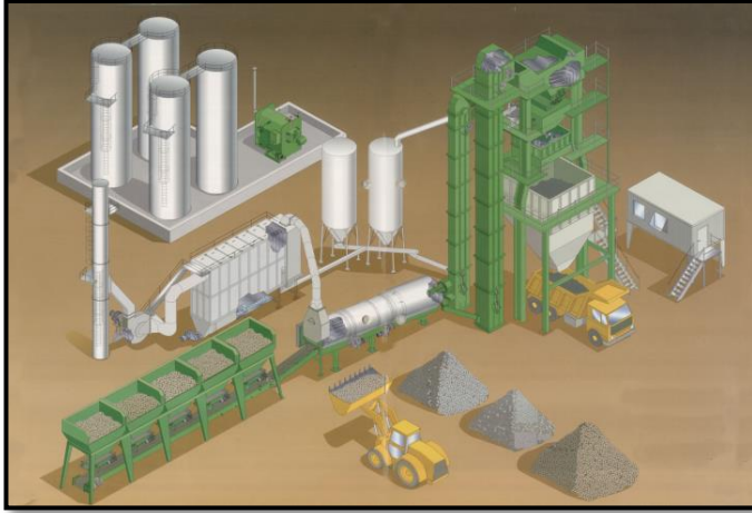
Şekil 5: Asfalt Üretim Tesisi Simülasyonu
