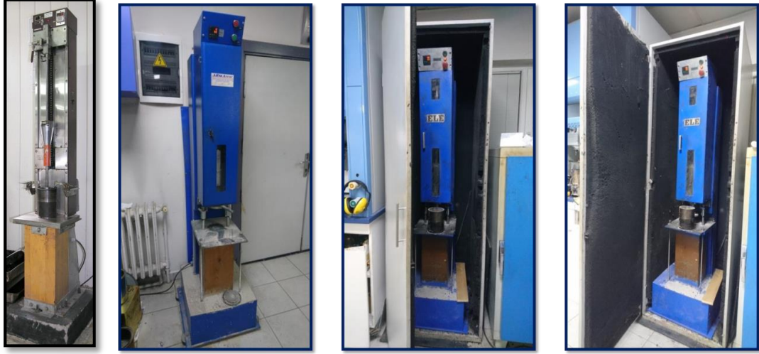
Resim 22: İSFALT Merkez Laboratuvarı – Cihazların Gürültü İzolasyonu
