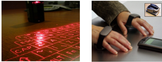
Resim 4.3. Geleneksel klavyenin yerini alabilecek klavye örnekleri. Solda, Sanal klavye . Yansıtılan görüntü klavye görüntüsüdür. Haptik algının yanılsaması olgusuna tipik bir örnek oluşturmaktadır. Sağda, Taşınabilir klavye . Ele giyilen aparatlarla parmakların hareketleri algılanır. Her iki örnekte de geleneksel tuşların yerini klavye görüntüsünün yansıtıldığı zemin almıştır. Haptik geribildirim, basılan tuş sertliği yerine, o an kullanılan zeminin özelliğine bağlı olarak çalışır.
