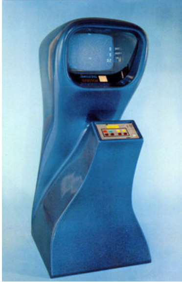
Şekil B.7. Computer Space oyunu için tasarlanan arcade oyun makinası
