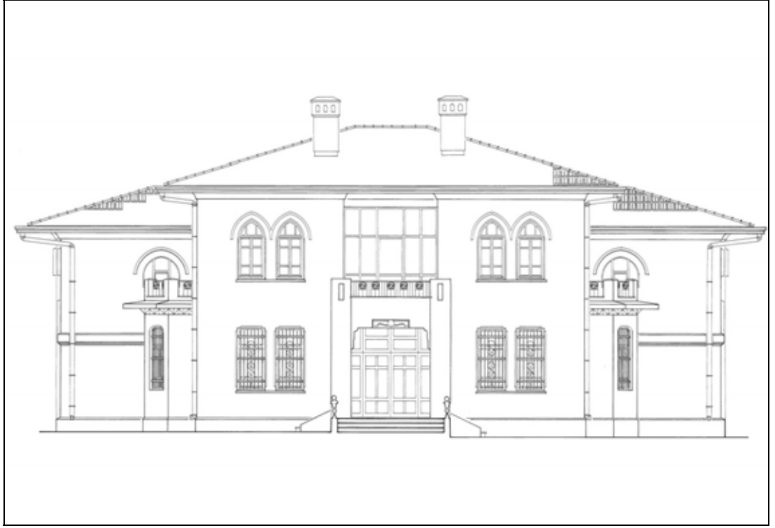
Sekil 3.25 Üsküdar Halkevi Giriş Cephesi ( Rölöve 2003, Mimar Sinan Üniversitesi Restorasyon Kürsüsü Arşivi)
