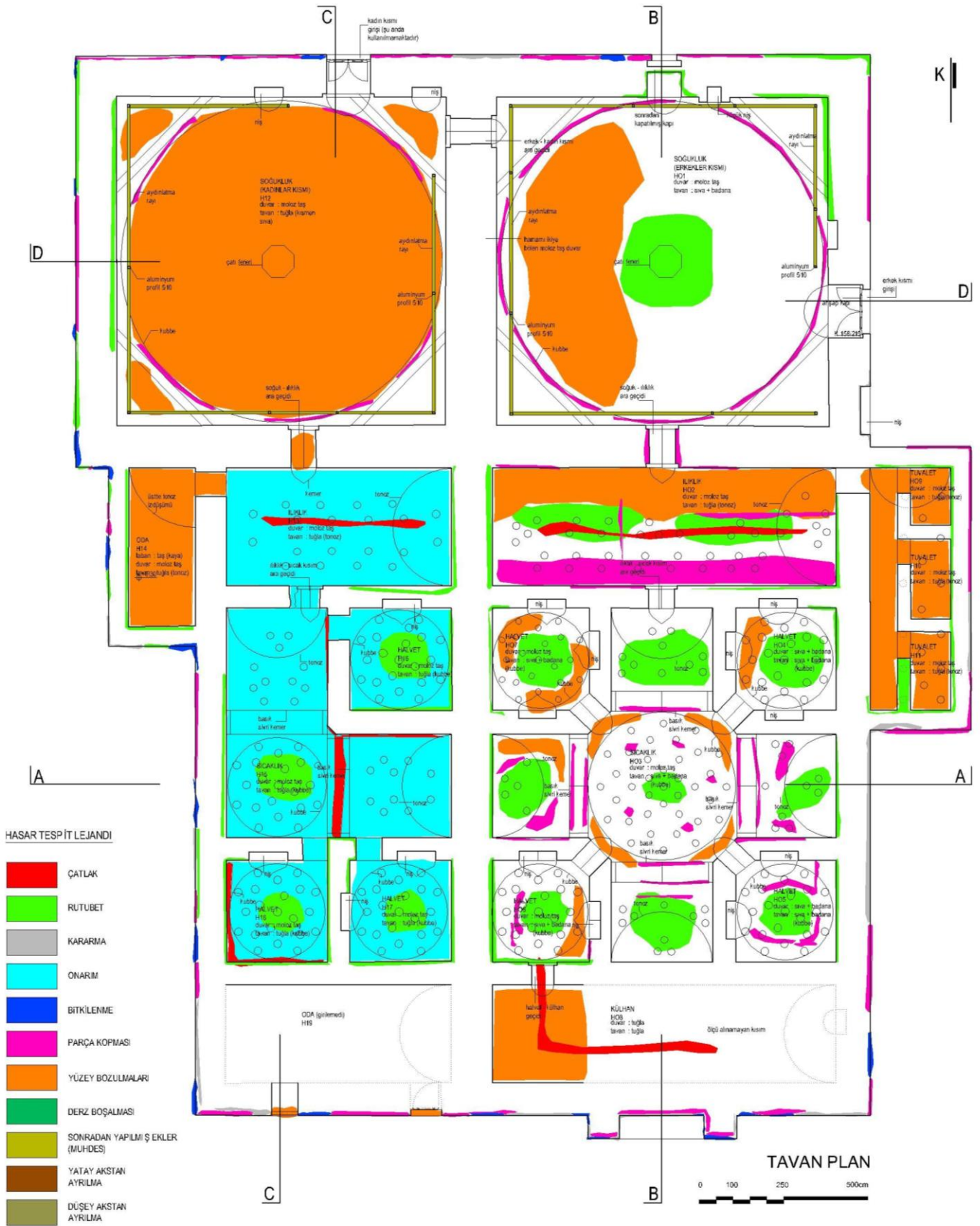
Çizim 4.26 Gazi Mehmet Paşa Hamamı – Analitik Rölöve (Hasar Tespiti) – Tavan Plan
