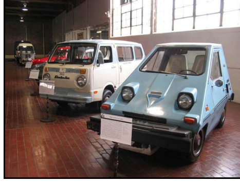
Şekil 3.21. Elektrikle çalışan Vanguard-Citicar(1977)
