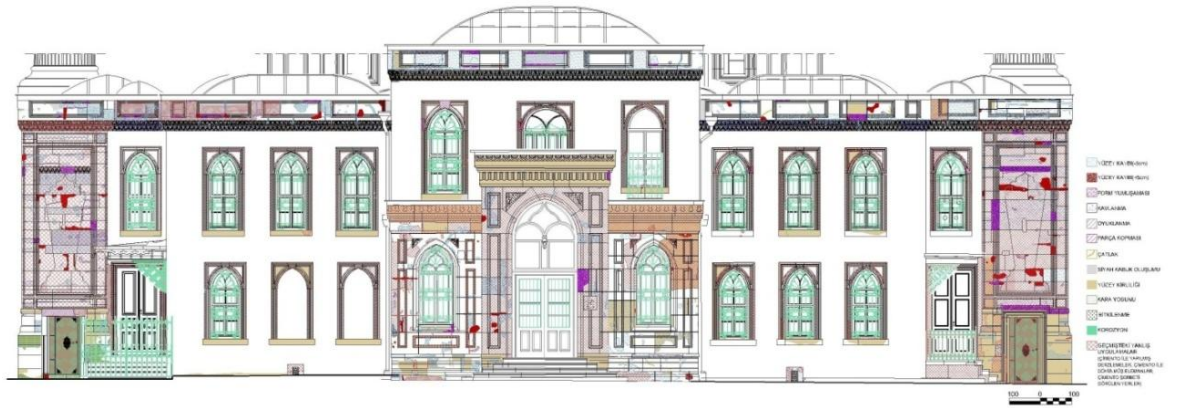
Çizim 4.36. Son cemaat kısmı kuzeybatı cephesi malzeme analizi [17]
