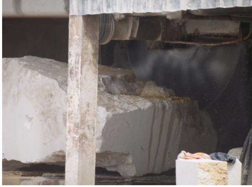
Resim 4.210. Ocakta taşların kesilmesi
