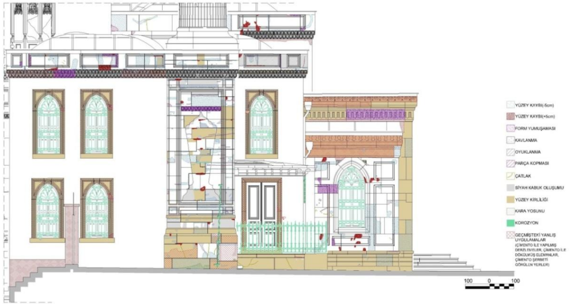
Çizim 4.35. Son cemaat kısmı kuzeydoğu cephesi malzeme analizi [17]
