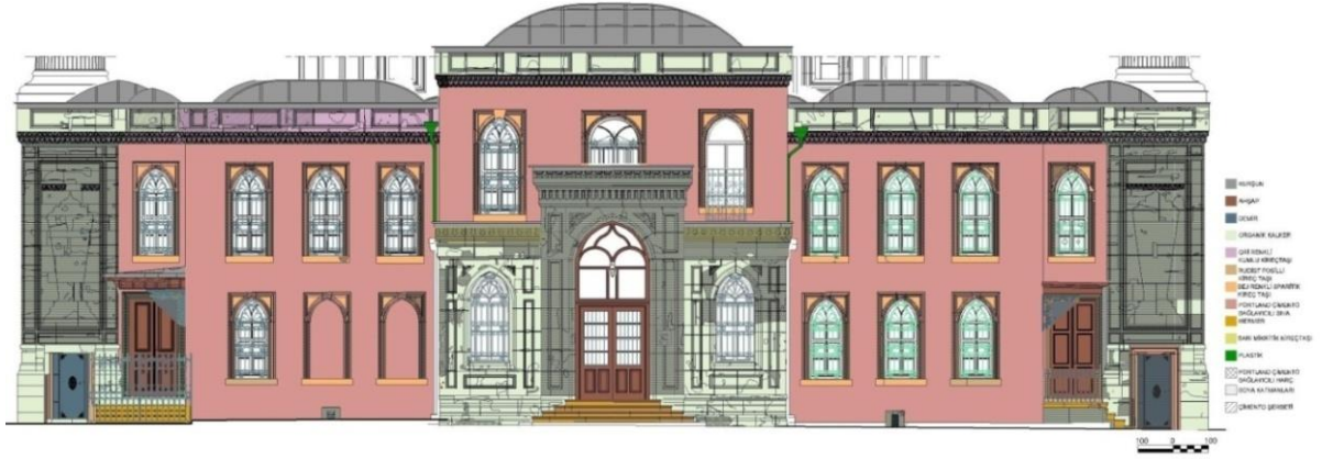
Çizim 4.28. Son cemaat kısmı kuzeybatı cephesi malzeme analizi [17]
