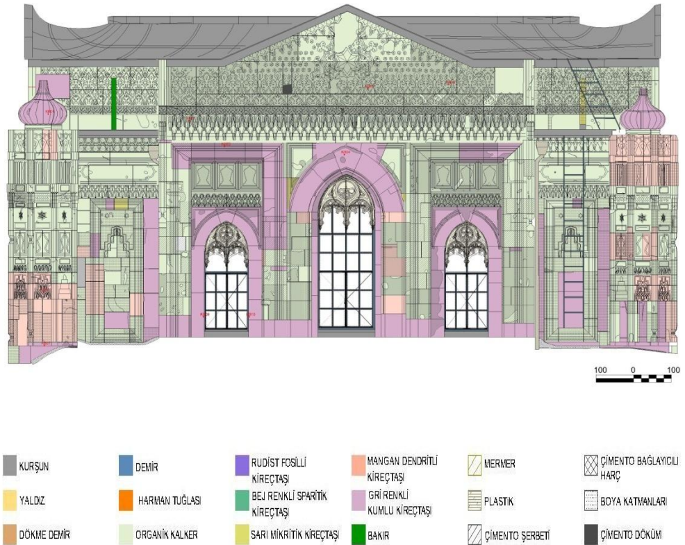
Çizim 4.22. Kuzeybatı cephesi malzeme analizi [17]
