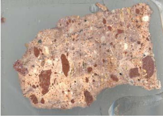
Resim 4.92. Özgün sıva örneğinin kalın kesiti [24]
