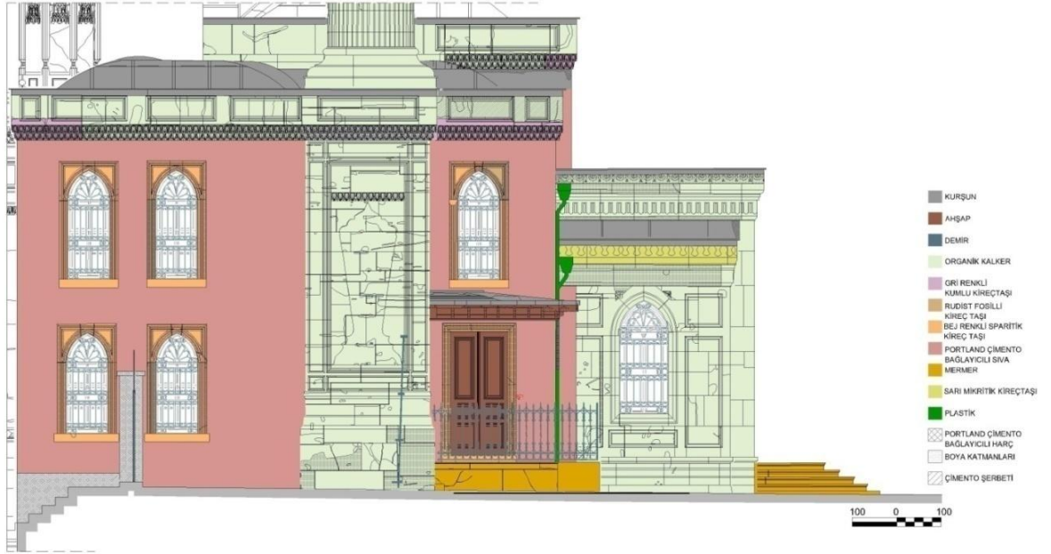
Çizim 4.27. Son cemaat kısmı kuzeydoğu cephesi malzeme analizi [17]
