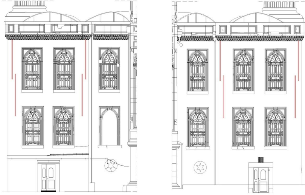
Çizim 4.49. Güneydoğu cephesi son cemaat kısmı dış duvarlarında mevcut olan kılıçlar [17]
