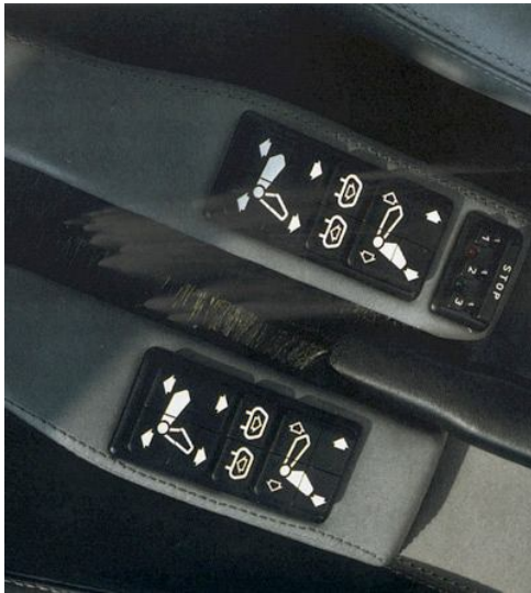
Resim 3.1 BMW sürücü koltuğunun ayarlama kontrol mekanizması.
