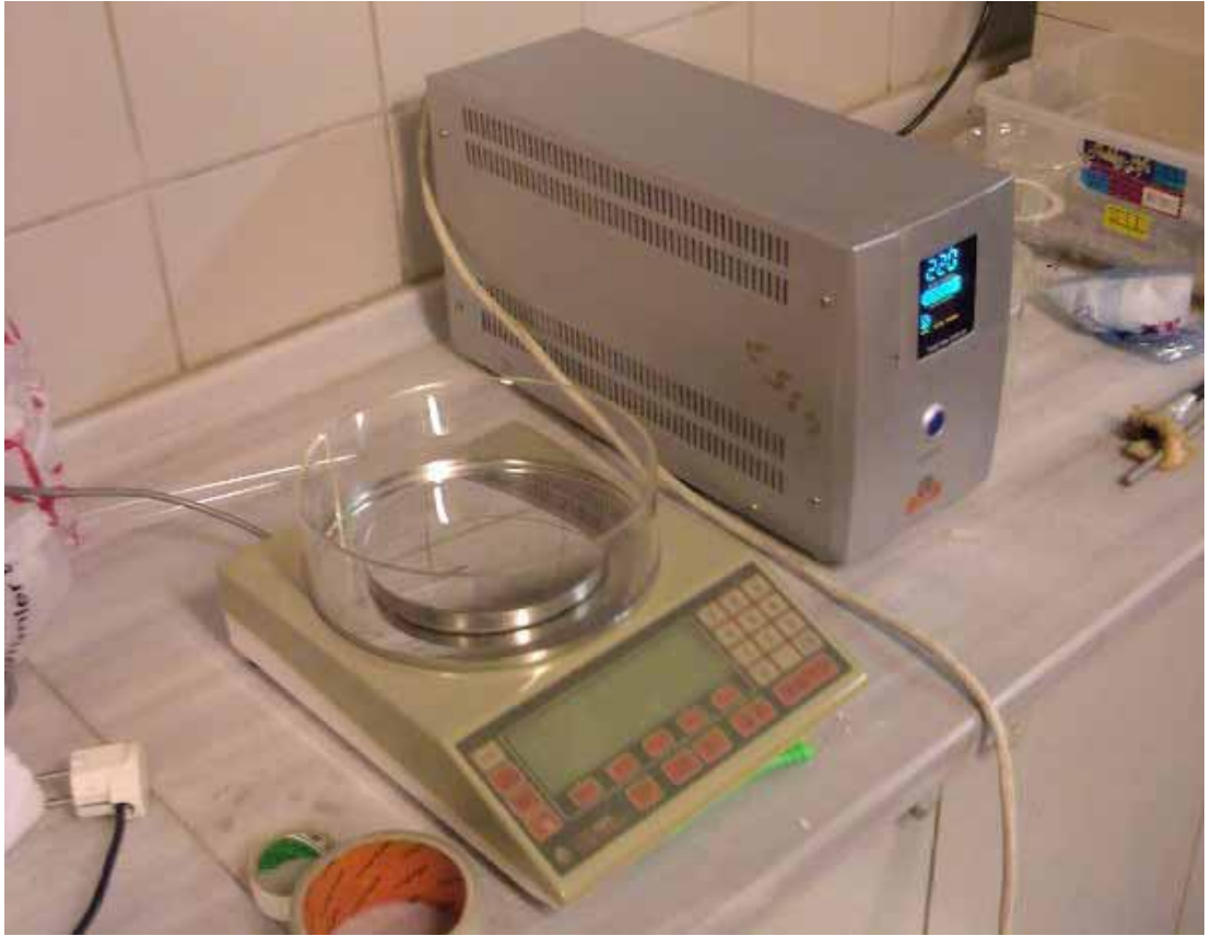
Resim 4-2-Analitik Terazi ve Kesintisiz Güç Kaynağı
