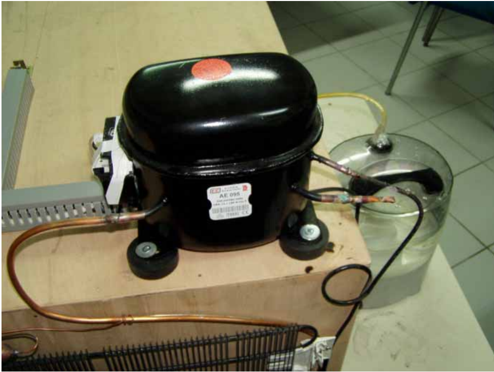
Resim 4-10-Soğutma Sistemi Dış Ünitesi
