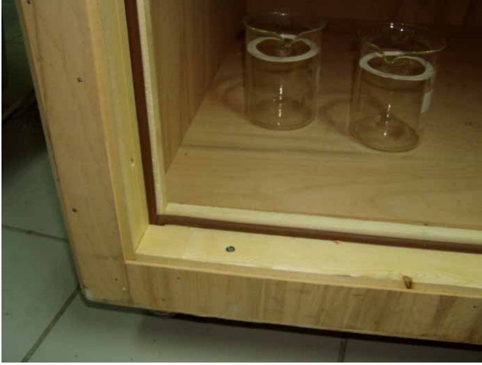
Resim 4-8-Hava Akımını Engellemek İçin Kullanılan Kapak Fitilleri
