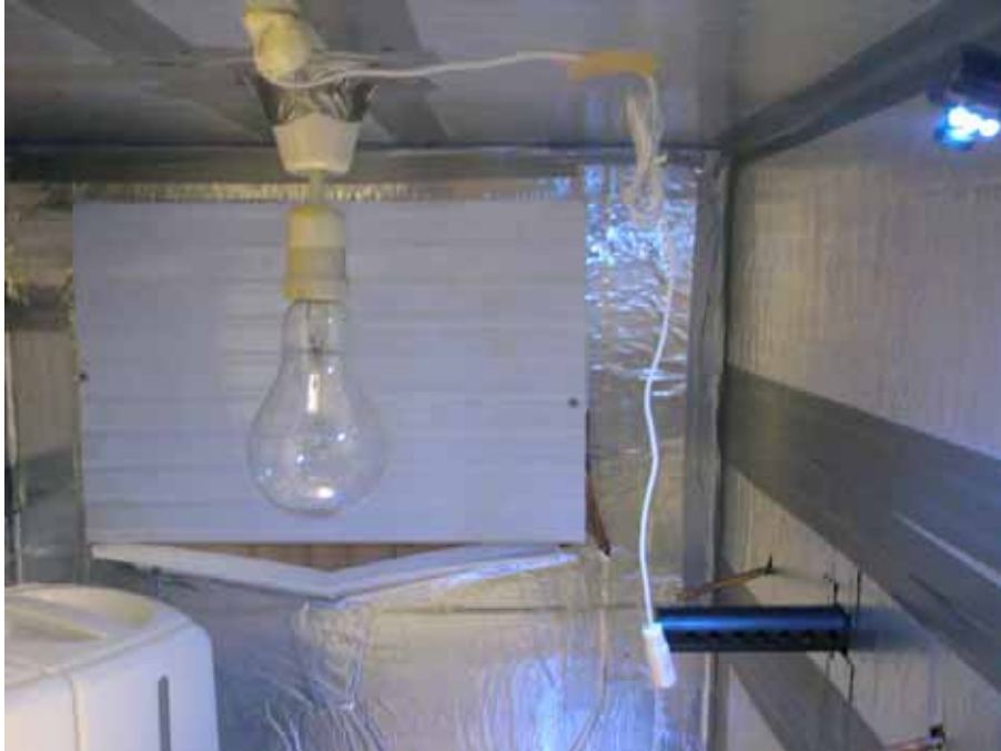
Resim 4-6- Cihaz Isıtma ve Soğutma Sistemi, Buhar Girişi, Duyargalar ve İç Ortam Kontrol Probu
