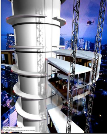
Resim 4.80: Dinamik kule taşıyıcı silindir Kaynak. http://www.dynamicarchitecture.net
