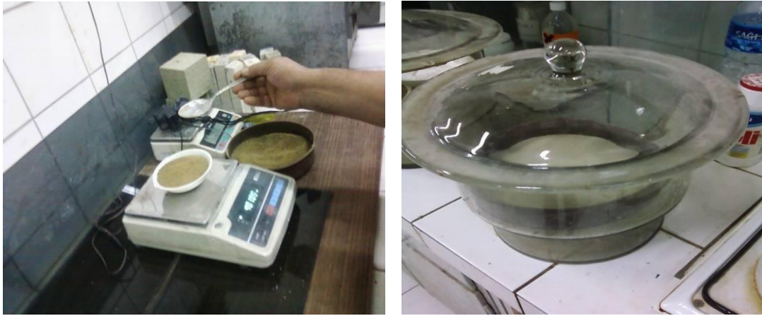
Şekil 3.1. Etüv sonrası desikatörde bekletilen malzemenin hassas terazide tartılması.
