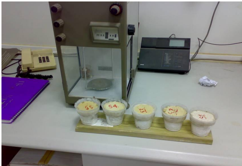
Şekil 4.12. Buhar Geçirgenliği Deney Numunelerinin (0.00001g) Hassas Terazide Tartılması
