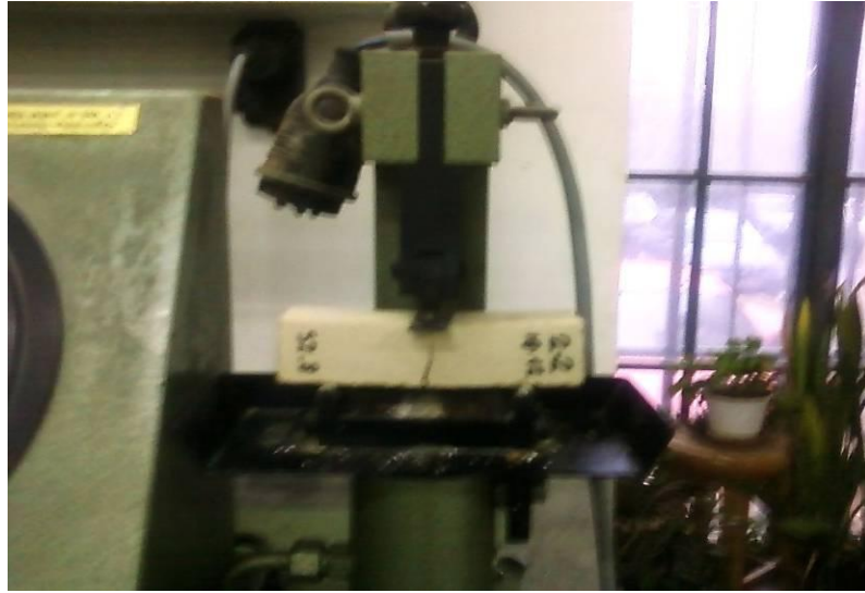
Şekil 4.13. Eğilmede Çekme Dayanımı Deneyinde Numunenin Kırılması
